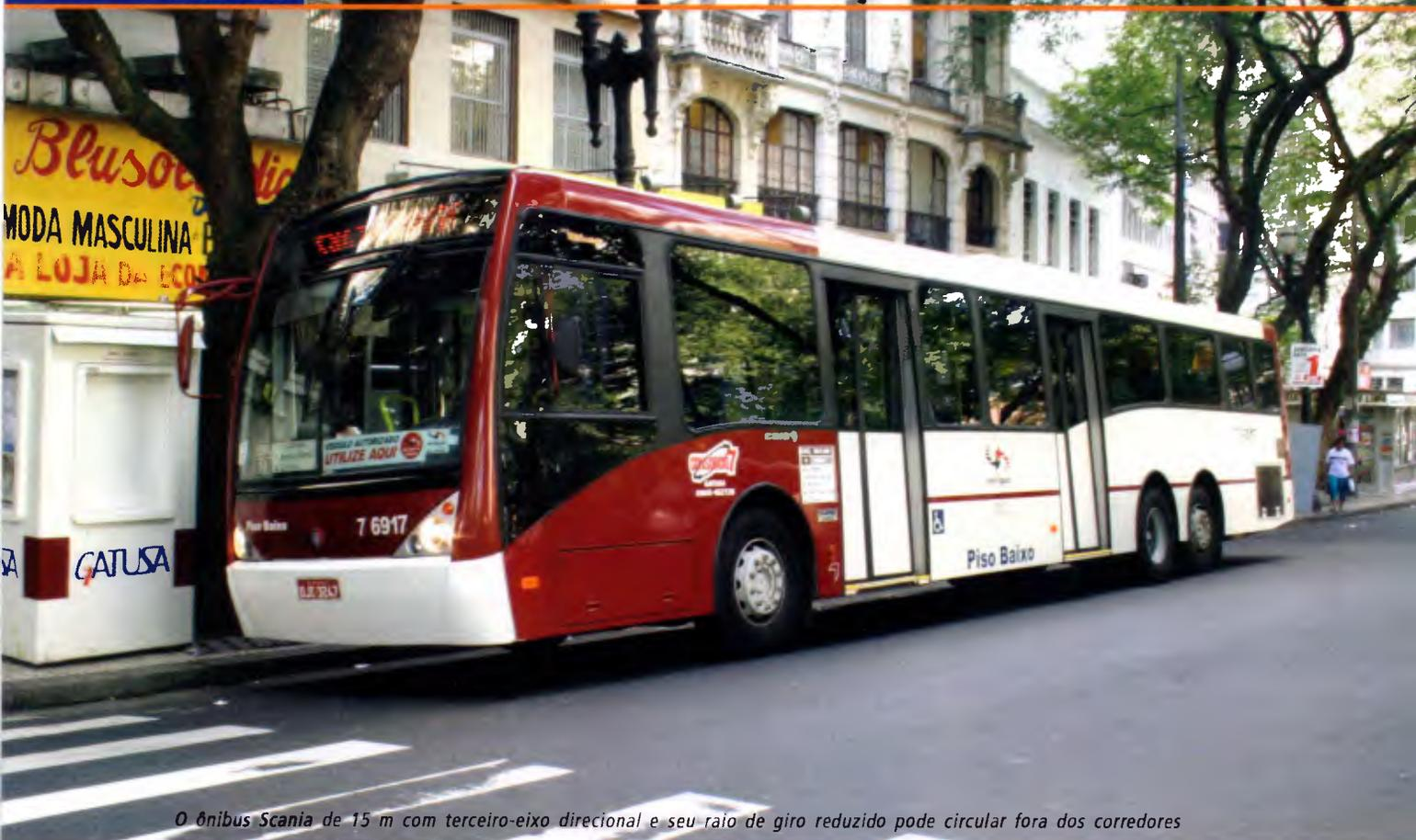
O ônibus Scania de 15 m com terceiro-eixo direcional e seu raio de giro reduzido pode circular fora dos corredores
