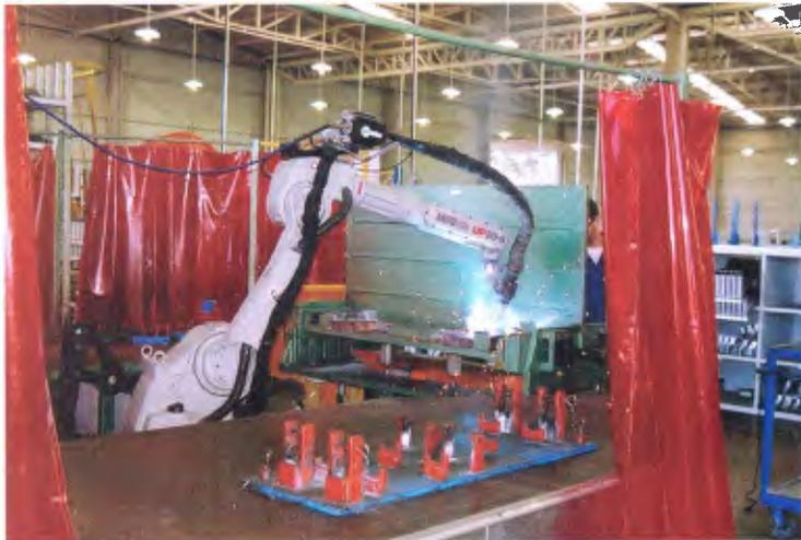
*Os processos de fabricação contam com robôs para soldagem...*
