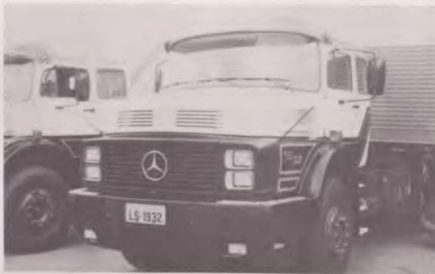
O LS-1932 alcança 320 cv com a aplicação do intercooler
