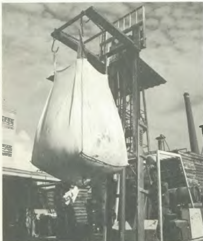
O contêiner flexível pode transportar até 1,5 t de grãos
