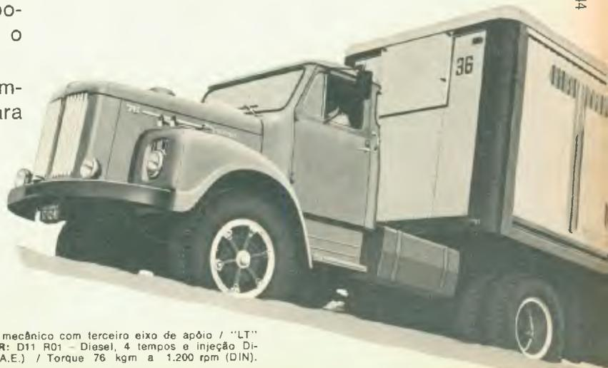
**MODELOS:** "L" Caminhão ou cavalo mecânico / "LS" Caminhão ou cavalo mecânico com terceiro eixo de apoio / "LT" Caminhão ou cavalo mecânico com tração também no terceiro eixo. **MOTOR:** D11 R01 - Diesel, 4 tempos e injeção Direta / 6 cilindros. Potência a 2.200 rpm / 195 C.V. (DIN) 210 H.P. (S.A.E.) / Torque 76 kgm a 1.200 rpm (DIN).
