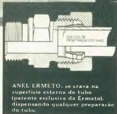
ANEL ERMETO: se crava na superfície externa do tubo (patente exclusiva da Ermeto), dispensando qualquer preparação do tubo.
