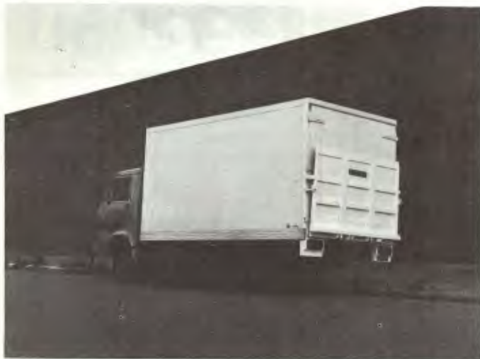
A plataforma carrega ou descarrega caminhões leves
