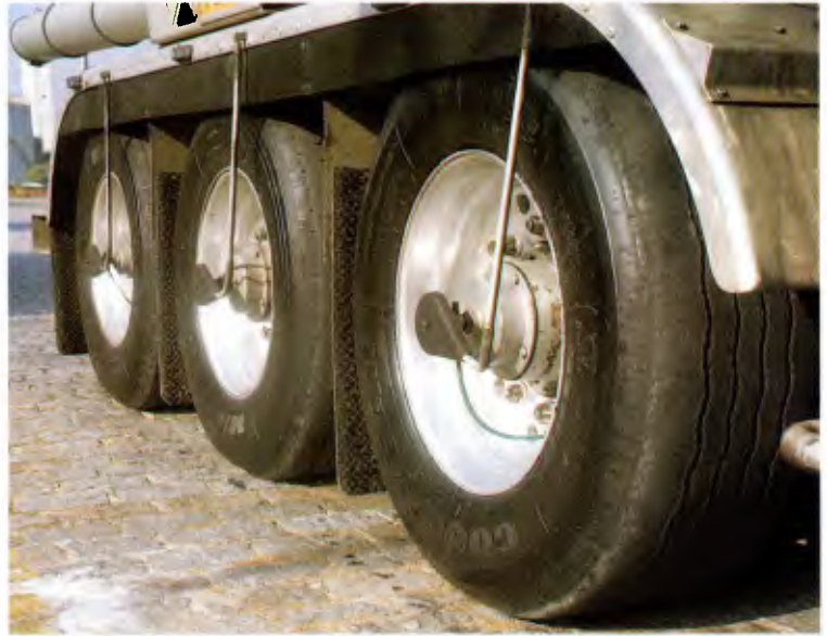
Pneu single na carreta da Esso para reduzir peso
