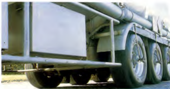
Single com rodas de alumínio: menos peso
