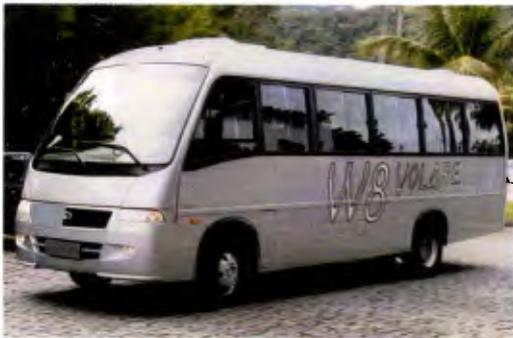
A Volare está colocando no mercado brasileiro um novo miniônibus com características mais robustas que os já conhecidos modelos A8, A6 e A5 e dimensões maiores: o W8 (foto), que tem 7,90 m de comprimento, 2,99 m de altura total – a interna tem 1,90 m – e 2,33 m de largura. Essas medidas permitem acomodar no interior do veículo até 35 passageiros sentados. Para aten-
