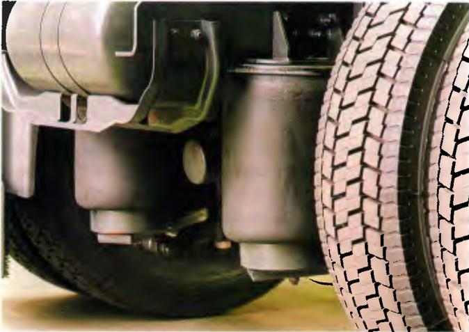
**Suspensão a ar nos cavalos: rapidez na carga e descarga**
