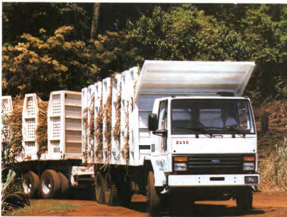
Cargo 2630, tração 6x4, com pbt de 26 t e capacidade de tração de 45 t
