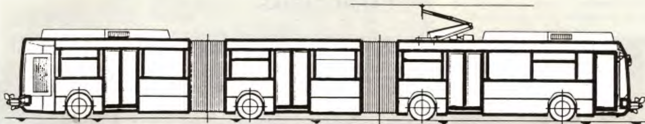
O sistema belga utiliza guia central, e os ônibus são elétricos e biarticulados, com maior capacidade de transporte
