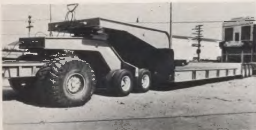
Carrega-tudo: leva até 110 t na plataforma de 9,50 m de comprimento.
