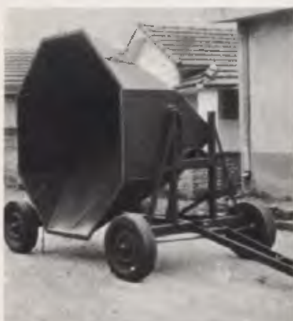
Carrinho de limpeza, em chapa de aço, descarrega por basculamento.
