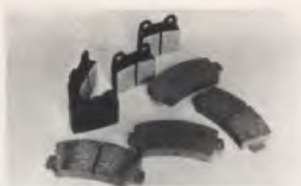
Pastilhas para freio a disco: o projeto exigiu demorados testes.
