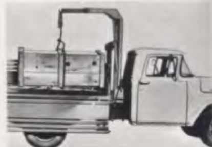
Guincho giratório: basta um só homem para descarregar um caminhão
