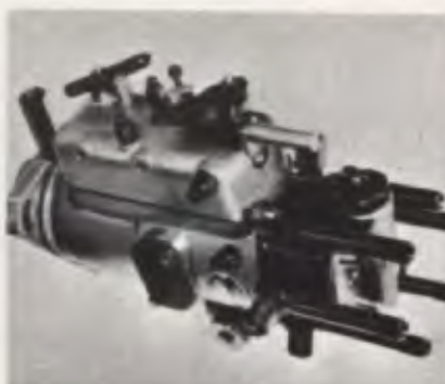
Esta bomba injetora assegura alimentação uniforme a cada injetor.
