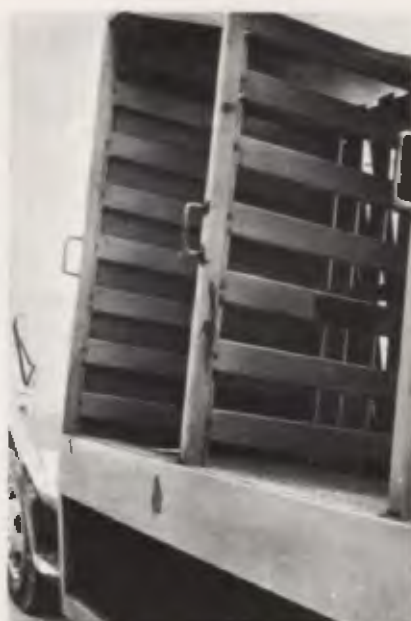
Com chapas de fibra de vidro, as carroçarias ficam 300 kg mais leves.
