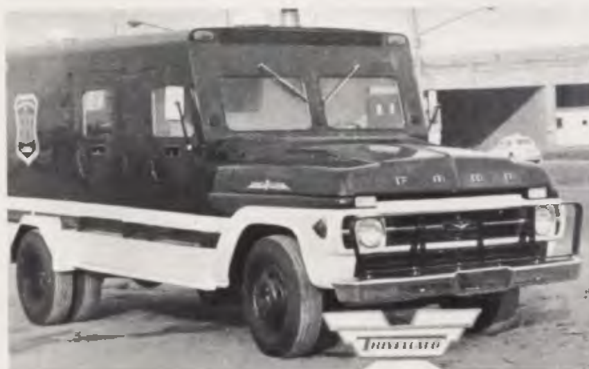
Neste veículo, o capô e a proteção do radiador são à prova de bala.
