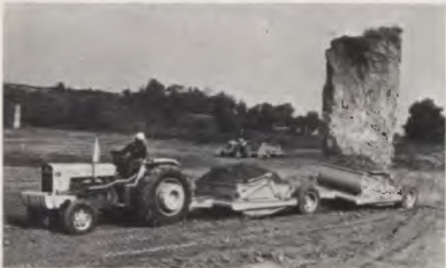
O trator MF-951 reboca scrapers com 3 900 kg de peso.
