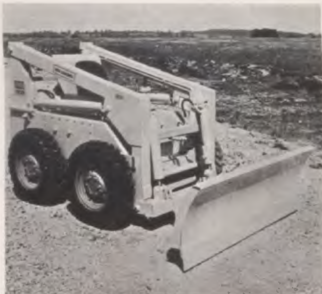
Uniloader: motor de 26 a 37 cv, diesel ou a gasolina.
