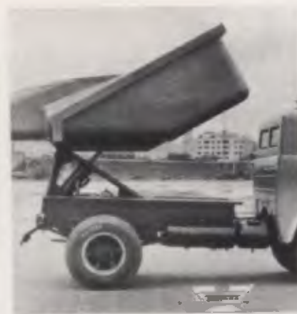
Escoamento do concreto é total.
