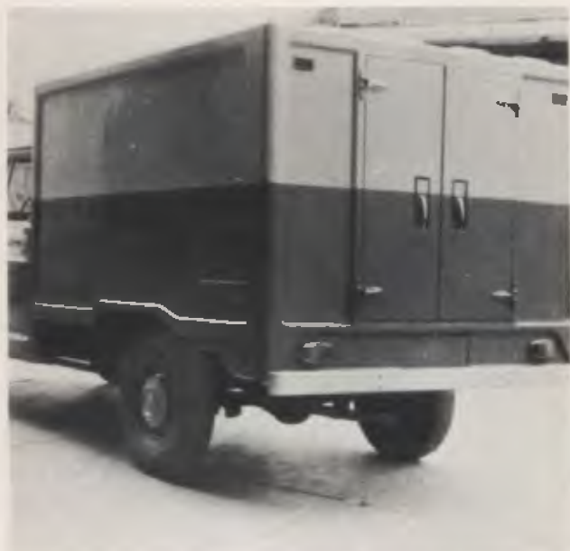
A carroçaria plástica resiste a ácidos e à corrosão.
