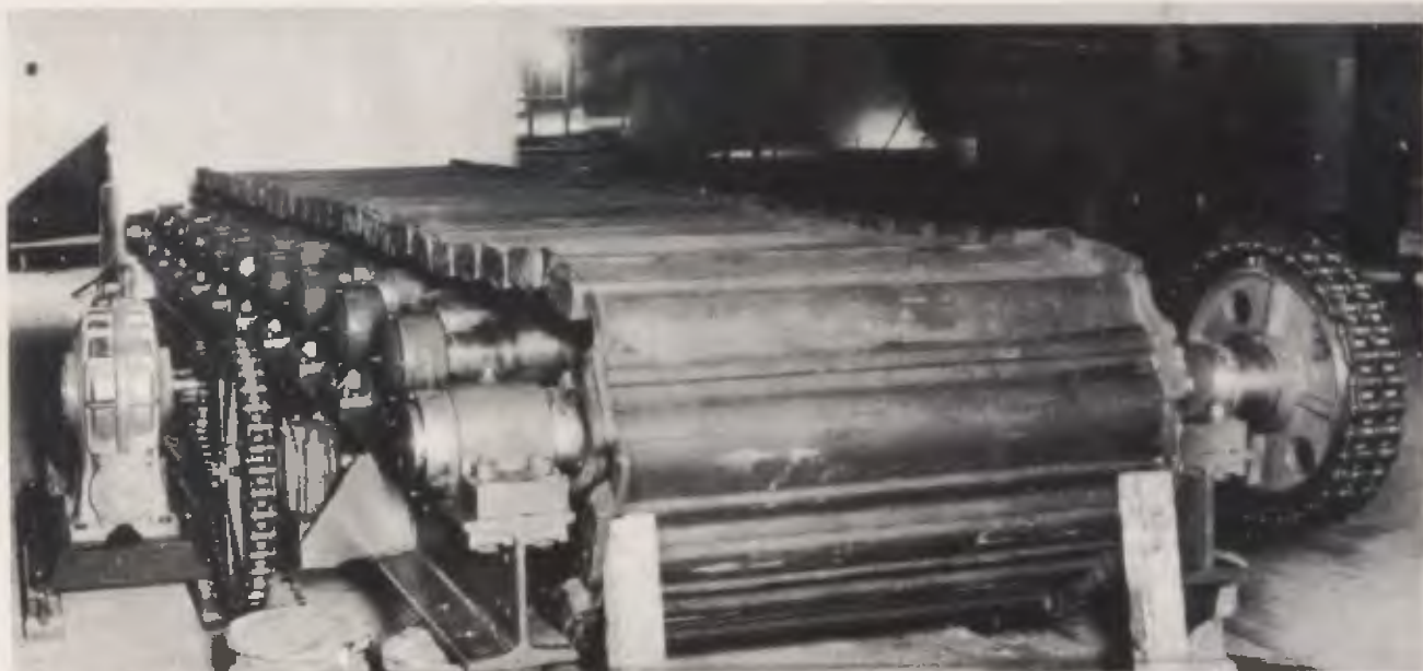
Transportador de aço especial: para conduzir minério até o britador, em condições severas de trabalho.
