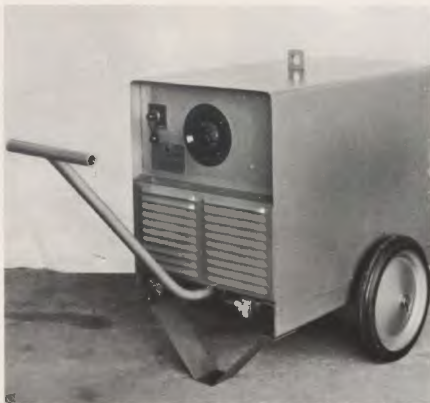
Retificador Bambozzi: pesa 200 kg e funciona com 90 V no arco livre.
