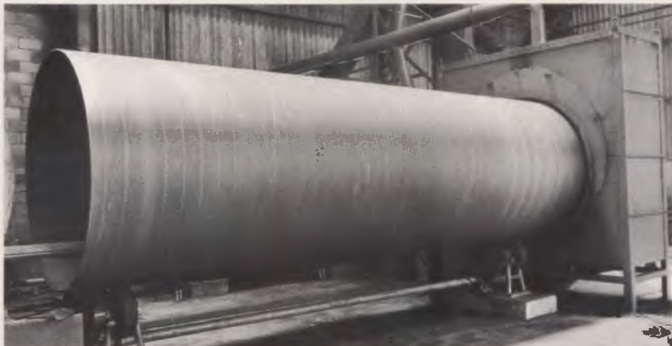
Na foto, um dos aspectos da produção: o tubo de aço passa por processo de revestimento interno e externo.
