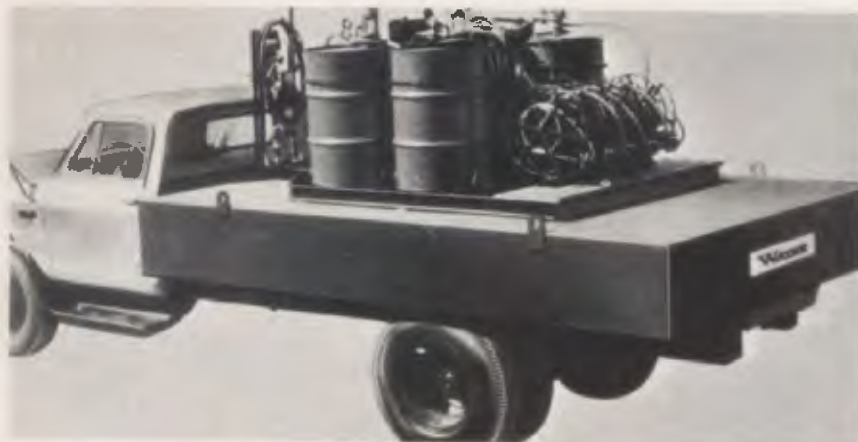
O tanque de 5 000 litros é um dos principais componentes da unidade.
