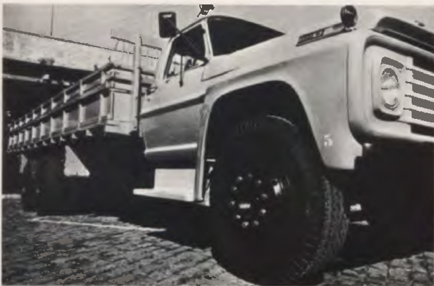
O F-750 vem com freio a ar e, opcionalmente, com direção hidráulica.
