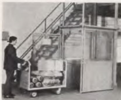
"Container lift", para transporte na vertical, dispensa o poço.
