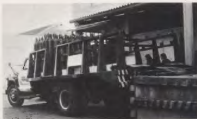
A caçamba nervurada é mais leve que as convencionais. Os cilindros são fixos por meio de cabos e roldanas.
