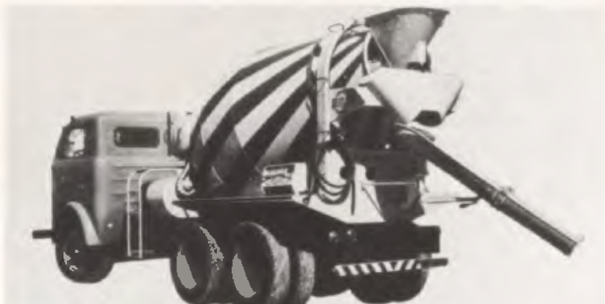
Betoneira para concreto: nova versão tem maior altura de descarga.
