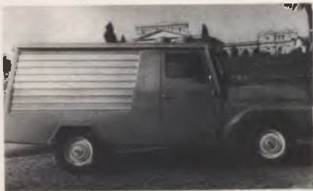
Neste carro, cofre, radiador e tanque são blindados.
