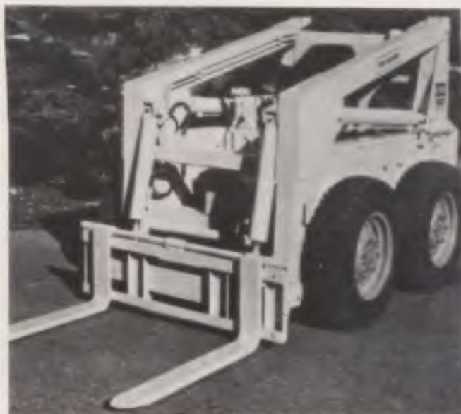
Este equipamento tem capacidade para 750 kg de carga.
