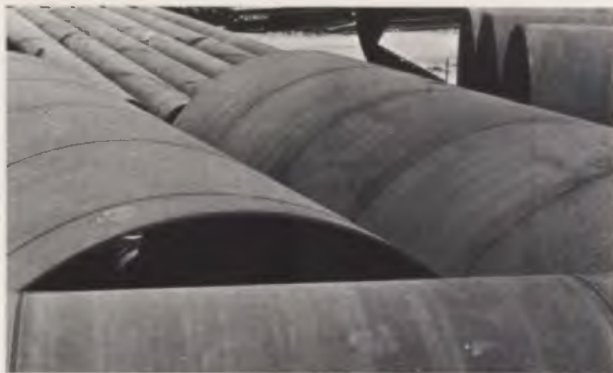
Numa das linhas de produção da Confab, os tubos são soldados sob controle de qualidade por meio de ultra-som e testes hidrostáticos.
