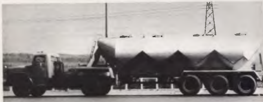
Saídas inferiores cônicas facilitam operações de descarga de granéis.
