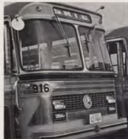
Externamente, frente e traseira são construídos em fibra de vidro.
