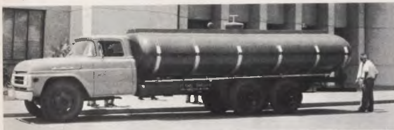
Leve e quimicamente inerte, o tanque plástico de resina com fibra de vidros é ideal para levar líquidos corrosivos.
