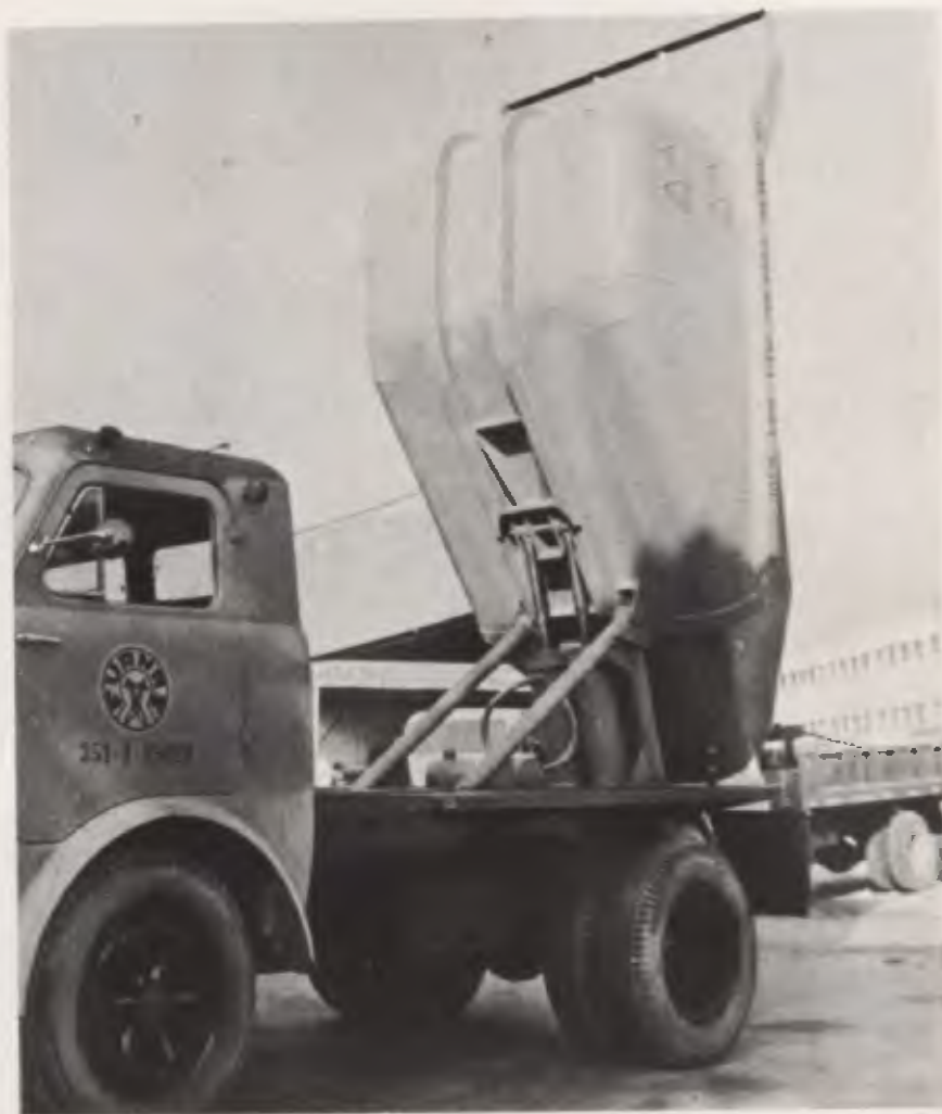
Caçamba de baixo centro de gravidade, bascula em qualquer ângulo.
