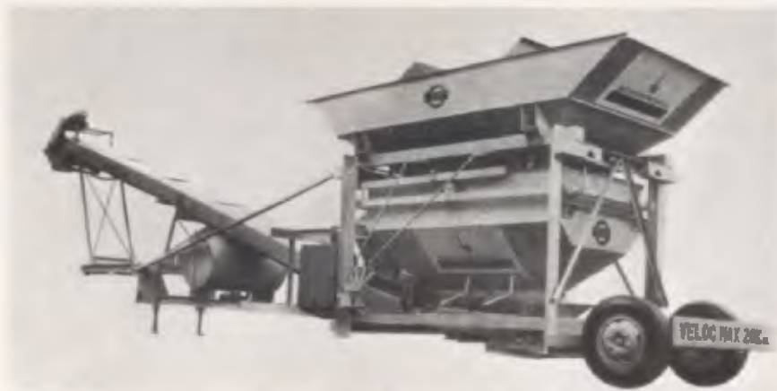
Mobilus 2: capacidade para 30 m 3 /h, com silo para 12 m 3 de agregado.
