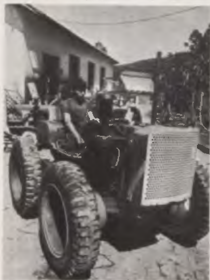
O novo motor com 5 cv a mais proporciona melhor tração ao trator.
