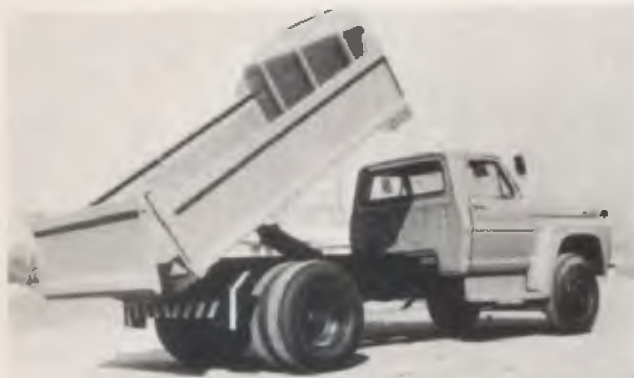
A caçamba nervurada é mais leve que as convencionais. Os cilindros são fixos por meio de cabos e roldanas.
