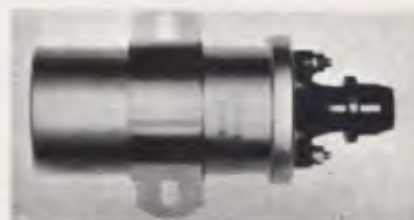
Bobina: é refrigerada a óleo.
