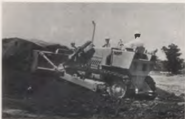
MF-3366: com conversor de torque na transmissão.
