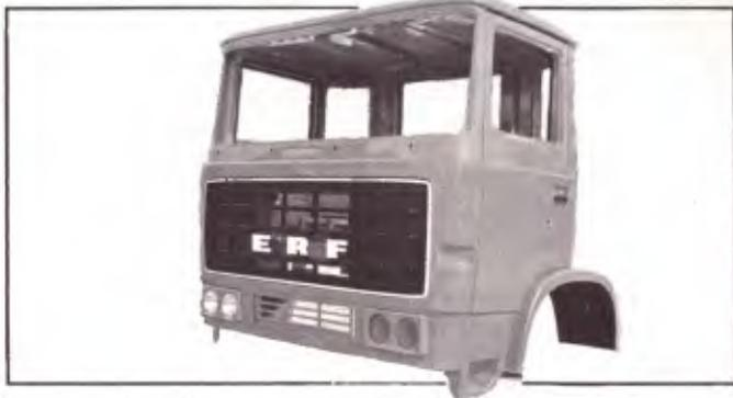
Do tipo "Tilt", a cabina consiste em 27 painéis diferentes (porta, cabina, teto, etc), custará 10% a menos que a convencional e poderá ser fabricada tanto para caminhões Ford quanto GM — bastam pequenas alterações na grade.
