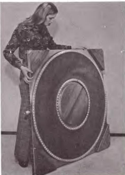
O colchão de água só requer tubos e mangueiras galvanizados e uma bomba de 25 hp. Mas é mais caro que o modelo a ar.
