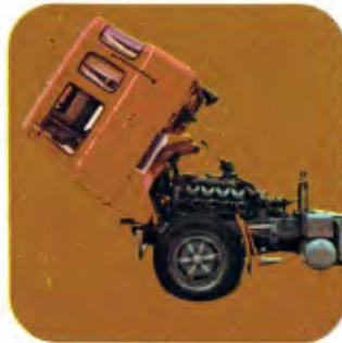
O basculamento hidráulico da cabina, exclusivo, funciona de maneira simples e rápida e pode ser efetuado com o veículo em qualquer posição - mesmo em funcionamento - oferecendo acesso total ao conjunto motriz com maior segurança.
