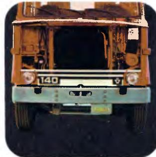
Para simples verificações de rotina, como inspeções do nível de óleo do motor, da direção hidráulica, do sistema de freios etc., basta levantar a grade frontal, sem perda de tempo ou desperdício de mão-de-obra, não necessitando de ferramentas especiais.
