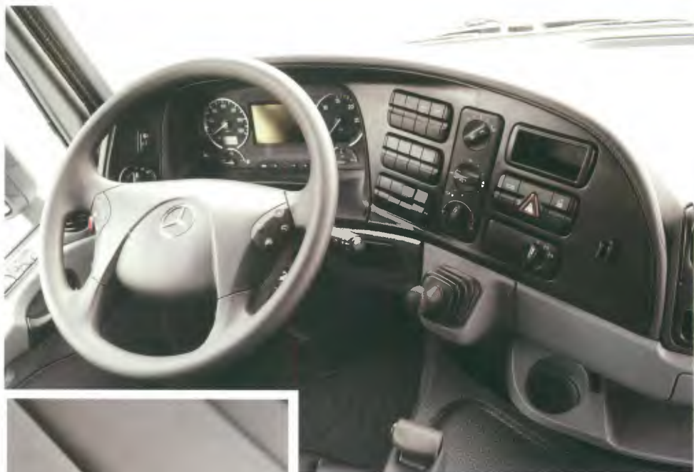
Cabine climatizada e câmbio semiautomatizado, que torna os engates mais suaves
