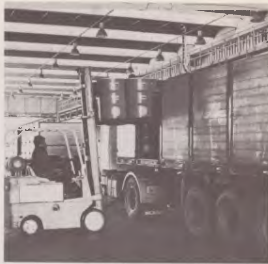
Cada carreta metálica transporta 96 tambores; o treminhão, 60t, é ajudado nas rampas por tratores e as telas economizam 500 kg
