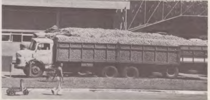
Cada carreta metálica transporta 96 tambores; o treminhão, 60t, é ajudado nas rampas por tratores e as telas economizam 500 kg
