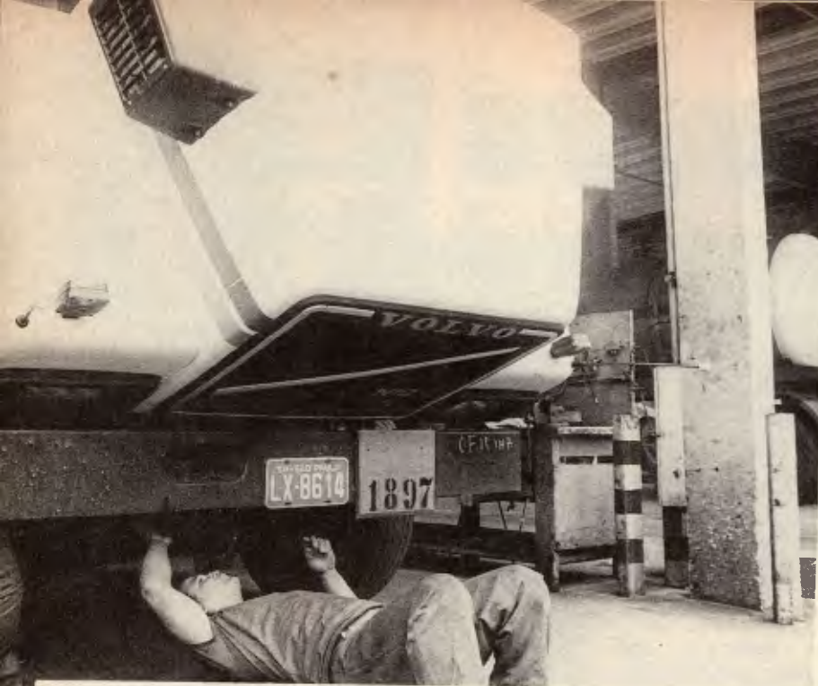
Graças à adoção de um teste de campo com o caminhão recém-chegado de viagem, Douglas Tacla, da Gafor, detectou a tempo de reparo um grave defeito no diferencial de um dos cavalos mecânicos da empresa
