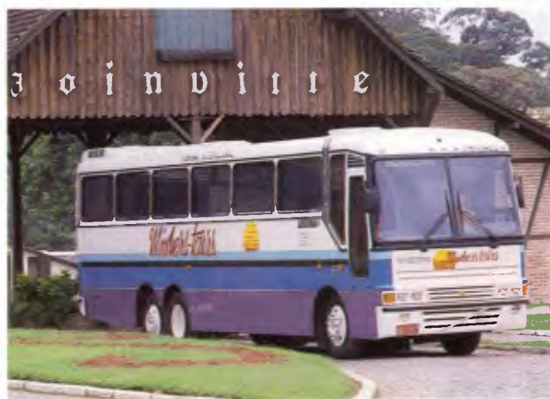
Chassi B58 (carroceria Marcopolo, modelo Torino)
