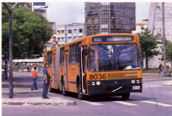
Chassi B 58 (carroceria Marcopolo, modelo Torino)
