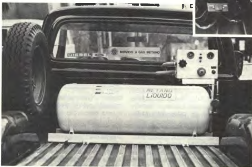
Na carroceria, o tanque criogênico. No painel (detalhe), a chave de conversão
