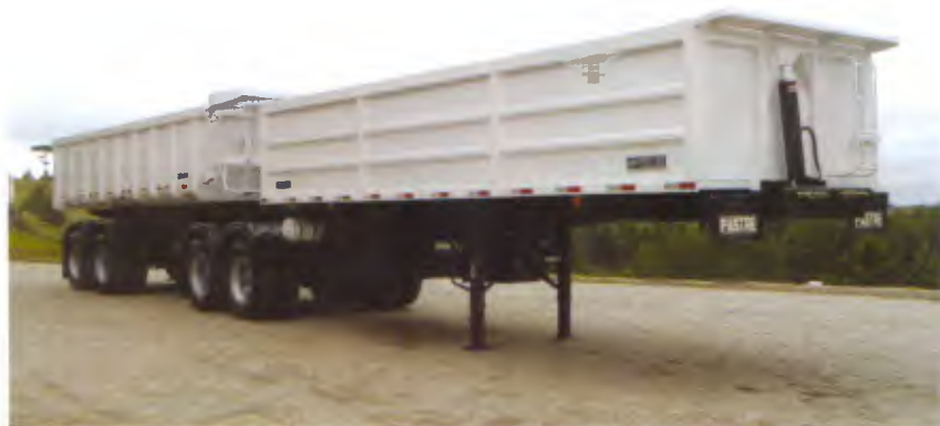
O Bitrem Basculante Geração II, da Pastra, é feito com aço especial, produzido na Suécia pela SSAB, e tem peso 25% inferior ao dos modelos semelhantes
