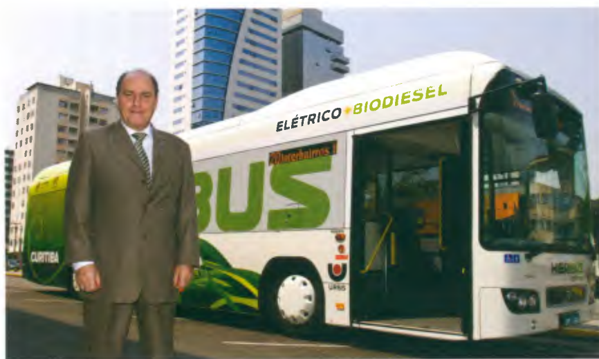
Luís Carlos Pimenta: tecnologia híbrida da Volvo permite economia de diesel de 35% e redução das emissões de gases entre 80% e 90%
