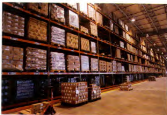
Estrutura de seis níveis para armazenagem de medicamentos, com 25 mil posições paletes
