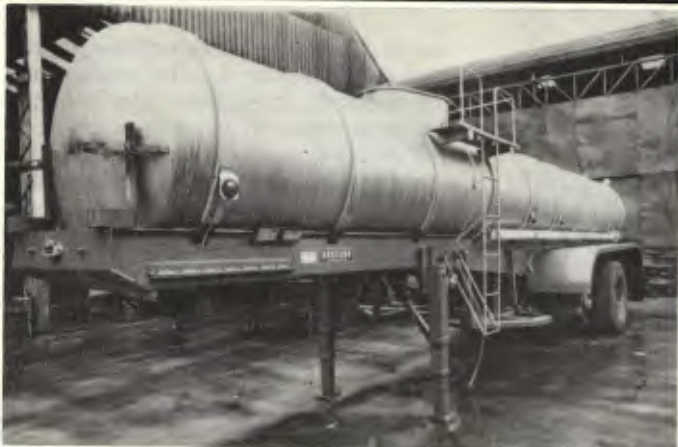
Goceano aconselha aço inox 316 L para aumentar vida útil
