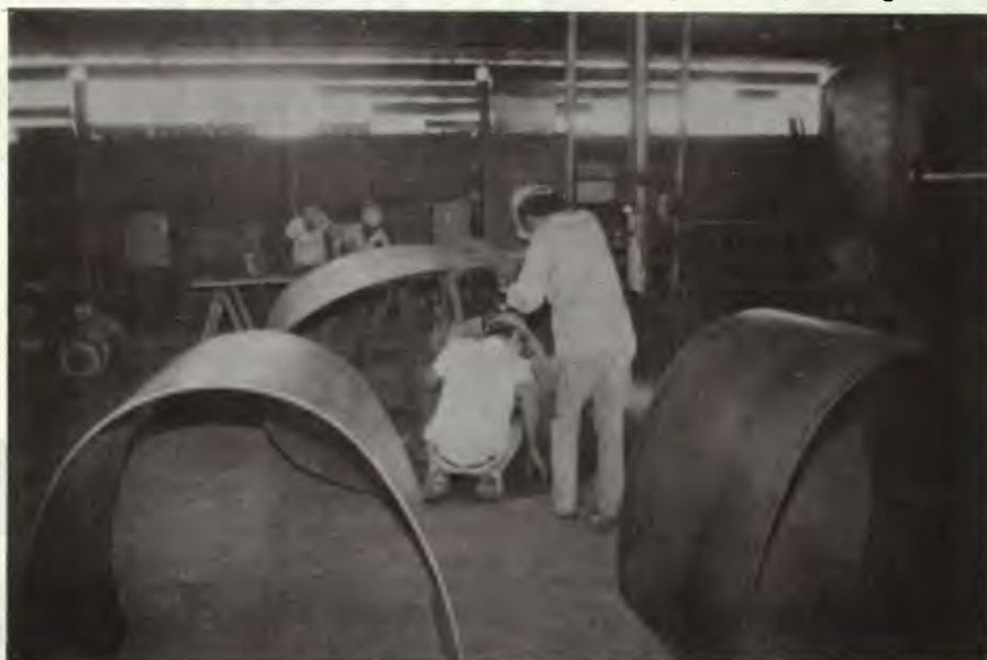
O aço inox é o material ideal, porém a maioria ainda é feita em aço carbono
