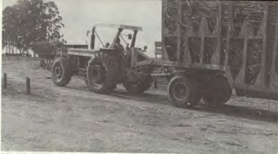
Nos aclives de até 8%, o trator sobe sem problemas com a aplicação de 1000 lb/pol 2
