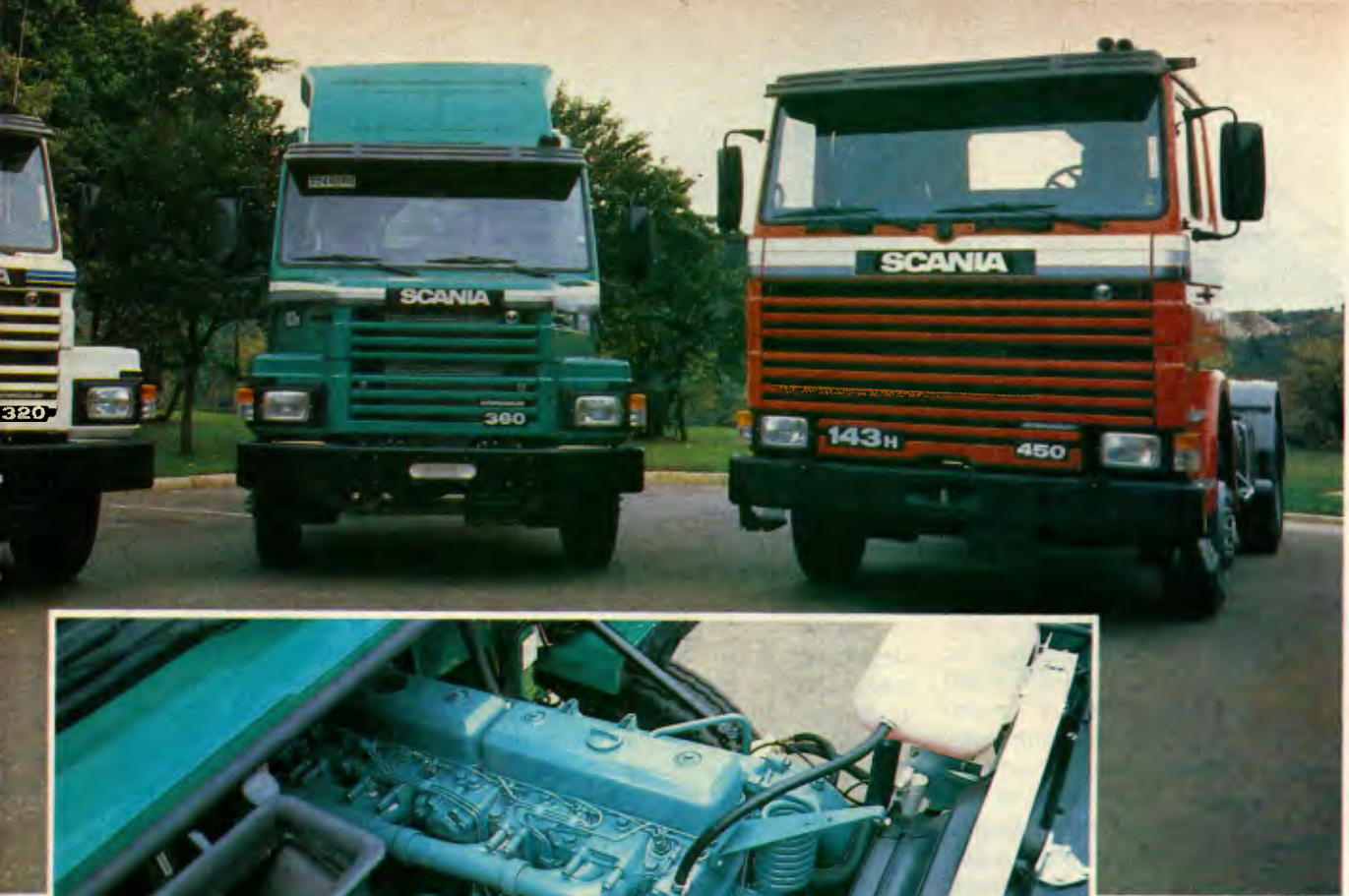
A nova família de motores de 11 litros possui bomba injetora com timing modificado de modo a combinar baixos níveis de consumo e emissão
