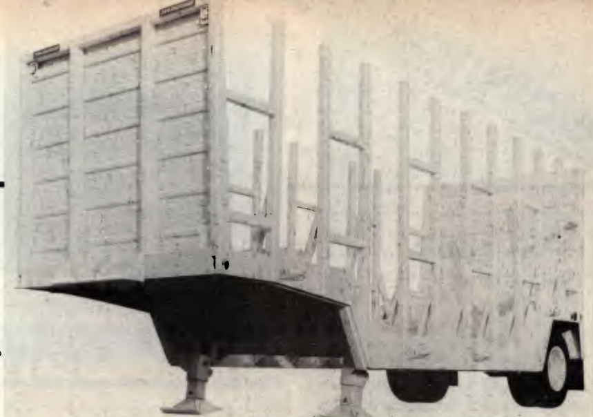
A carroçaria em aço é mais leve e a suspensão com molas reforçadas suporta mais carga
