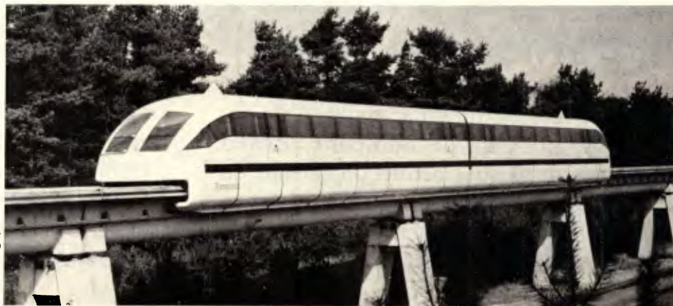
O Transrapid 07 desenvolve até 500 km/h e leva 1 060 pessoas em composição de dez carros
