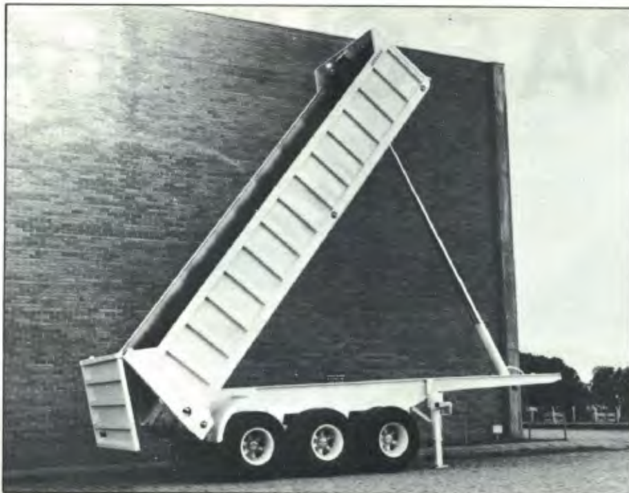
Semi-reboque com cilindro frontal: transporta até 1 200 kg a mais
