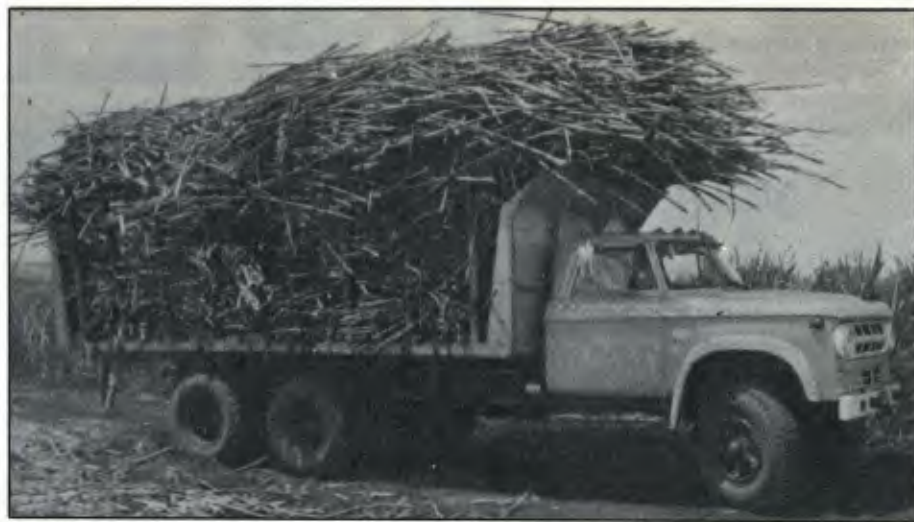
A caixa de conversão transforma caminhões comuns em foras-de-estrada
