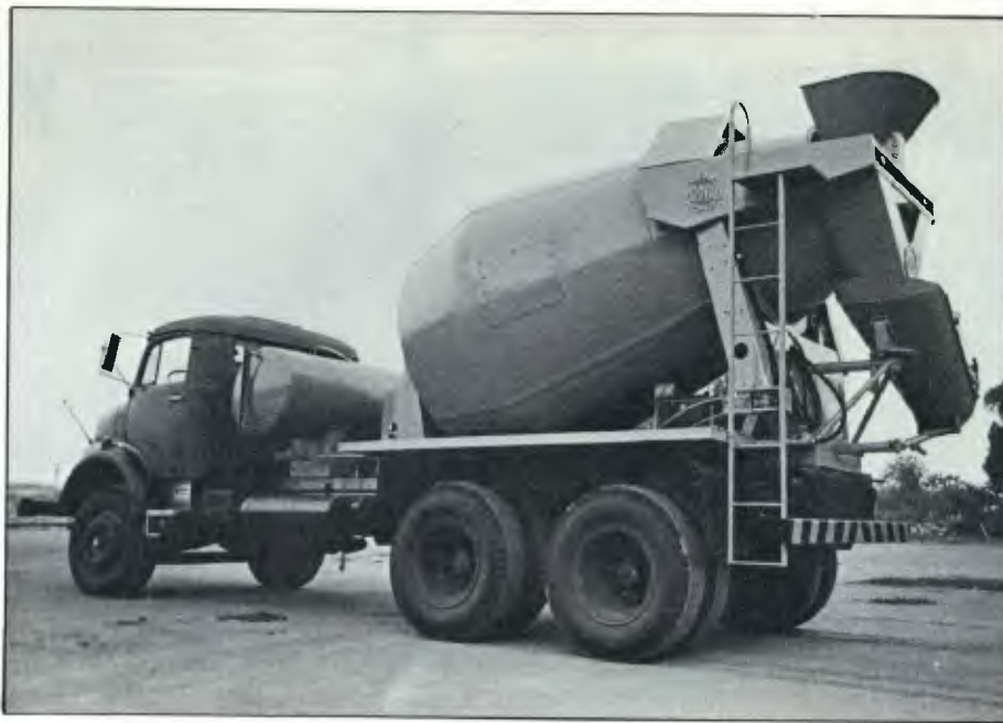
Nesta betoneira, o próprio redutor encarrega-se de fazer a transmissão
