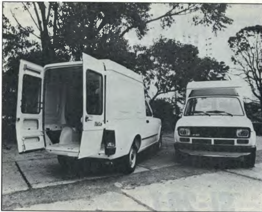
Fiorino: Com apenas 3,80 m de comprimento, leva 450 kg de carga
