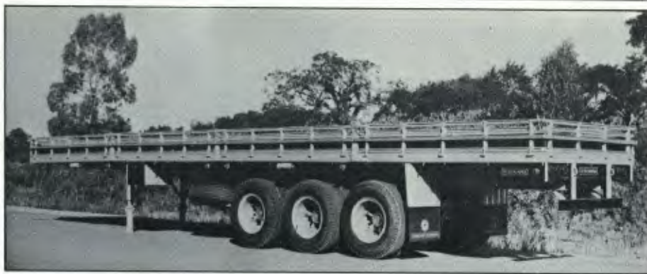
Com 12,36 m de comprimento, o semi-reboque de três eixos pesa 6 mil kg
