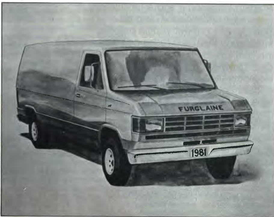
"Furglaine": furgão monobloco para 1 400 kg, montado sobre chassi F-100
