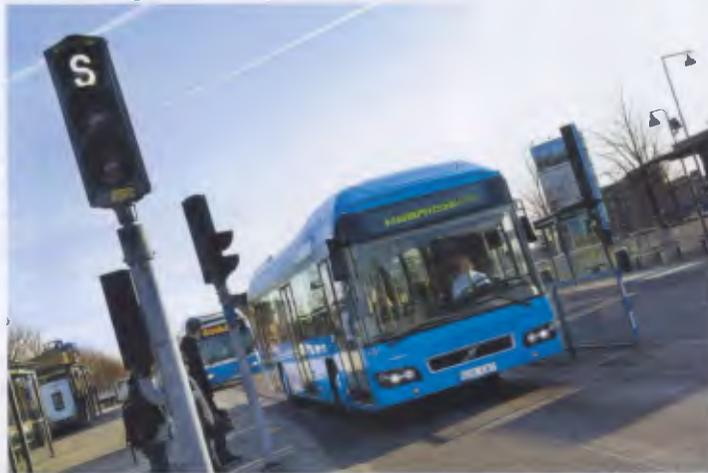
híbrido da Volvo proporciona economia de combustível, graças aos dois motores que podem trabalhar em conjunto ou isoladamente – um a diesel e outro elétrico. O ônibus parte movido pelo motor elétrico e, quando atinge velocidade de 15 a 20 quilômetros por hora,
