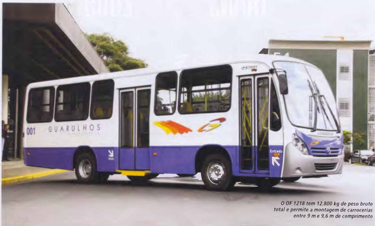
*O OF 1218 tem 12.800 kg de peso bruto total e permite a montagem de carrocerias entre 9 m e 9,6 m de comprimento*
