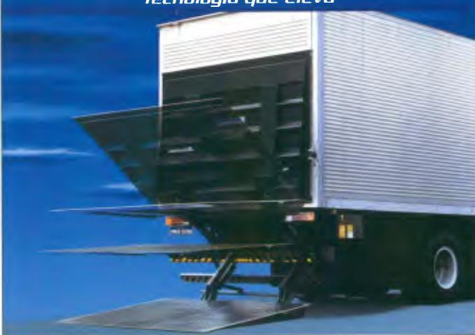
**Plataforma Elevatória de Carga Veicular**
