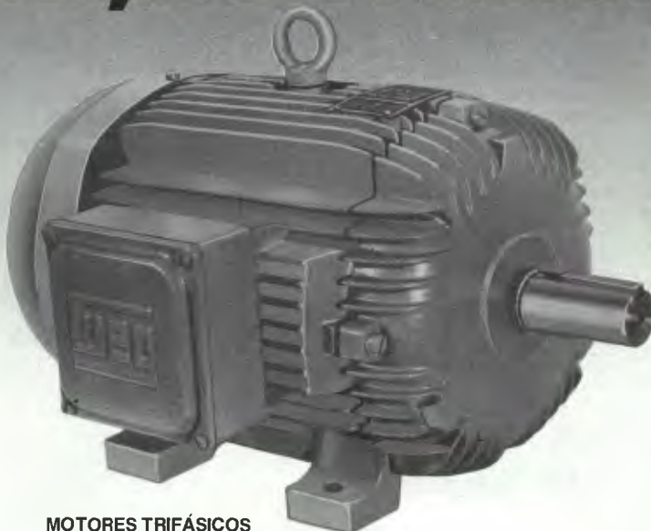
Com grau de proteção IP.54, de aplicação geral, e IP(W).55 para ambientes agressivos, indústrias química e naval. Potência de 0,16 a 500cv. Também para funcionamento em duas velocidades (1.800/3.600 e 900/1.800rpm), nas potências 0,25/0,4 a 160/250cv.
