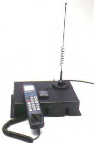
Controlcel: o link de conexão, entre veículo e central, é realizado por meio de telefonia celular
