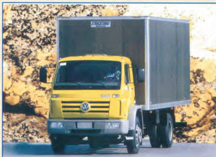
Modelo: 13.180 4x2 Entre-eixos: 3.560 mm, 4.340 mm, 4.800 mm, 5.207 mm Motor: MWM 6.10 TCA, 180 cv a 2.800 rpm PBT: 23.000 kg
