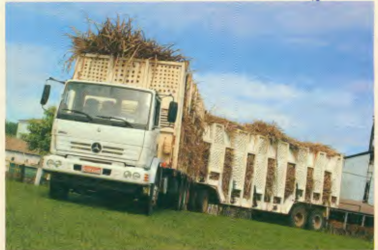
Modelo: 2429 6x4 Entre-eixos: 4.830 mm+1.350 mm Motor: OM 906 LA, 279 cv PBT: 26.500 kg PBTC: 45.000 kg, 63.000 kg
