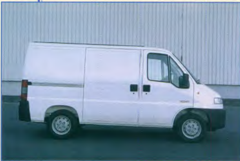
Modelo: Boxer Furgão Curto Entre-eixos: 2.850 mm, 3.200 mm Motor: 103,3 cv a 3.600 rpm PBT: 3.300 kg
