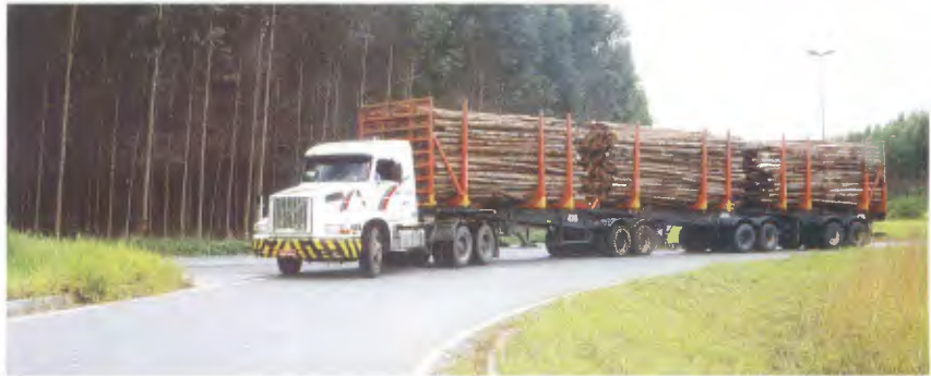
Tri-trem de nove eixos, para 74 toneladas brutas, na operação de extração de madeira para a produção de celulose
