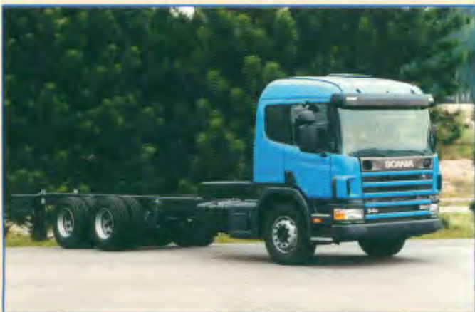
Modelo: P94 DB 6x2 NA Entre-eixos: 5.100 mm, 5.500 mm Motor: DSC9 12, 260 cv a 2.000 rpm PBT: 25.700 kg PBTC: Até 30.000 kg
