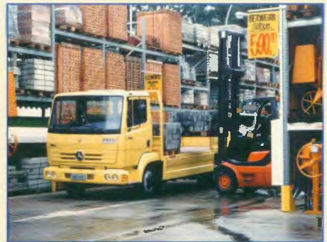
Modelo: 712 C 4x2 Entre-eixos: 3.150 mm, 3.700 mm Motor: OM 904 LA, eletrônico, 122 cv PBT: 7.700 kg
