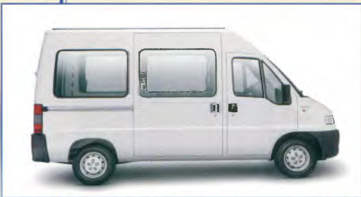
Modelo: Ducato Vetrato 4x2 Entre-eixos: 3.200 mm Motor: Sofim 2.8 Turbodiesel, 103 cv a 3.600 rpm PBT: 3.300 kg
