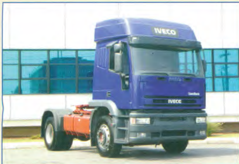
Modelo: EuroTech 4x2 Entre-eixos: 3.800 mm Motor: 370 cv a 1.900 rpm PBTC: 45.000 kg
