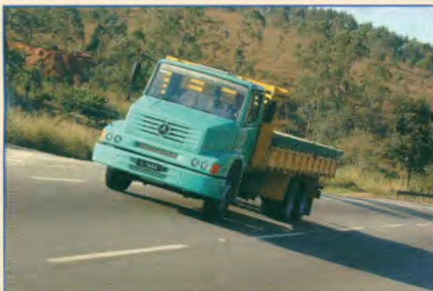
Modelo: 1622 6x2 Entre-eixos: 5.170 mm+1.360 mm Motor: OM 924 LA, 218 cv PBT: 22.000 kg, 23.000 kg
