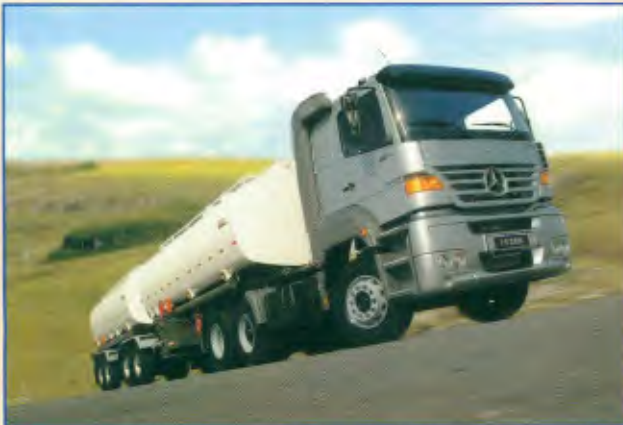
Modelo: 1938 S 6x2 Entre-eixos: 3.300 mm+1.295 mm Motor: OM 457 LA, 380 cv PSTC: 45.000 kg, 80.000 kg
