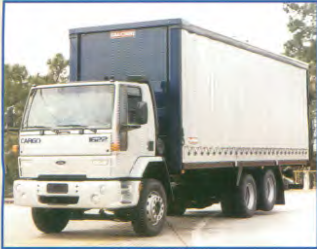
Modelo: Cargo 1622 6x2 Entre-eixos: 3.560 mm/4.900 mm Motor: Cummins, B5.9, 218 cv a 2.200 rpm PBT: 16.000 kg
