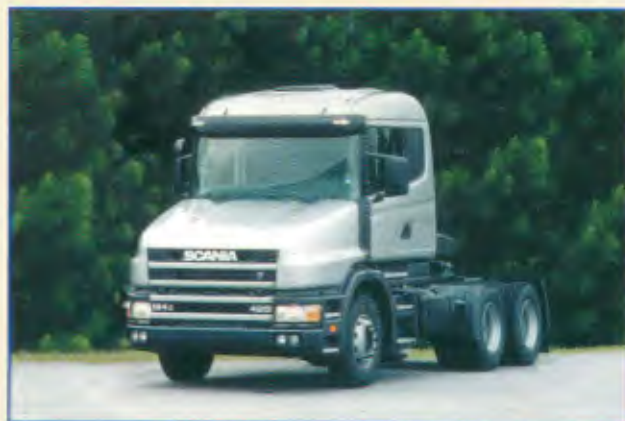
Modelo: T124 GA 6x4 NZ Entre-eixos: 3.700 mm Motor: DSC12 05, 420 cv a 1.700/1.300 rpm PBT: 27.700 kg PBTC: Até 78.000 kg
