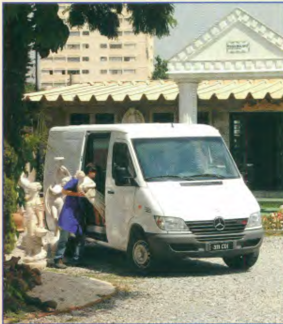
Modelo: Sprinter 311 CDI 4x2 Entre-eixos: 3.000 mm, 3.550 mm Motor: OM 611, 109 cv PBT: 3.550 kg
