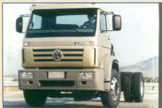
Modelo: 17.310 4x2 Entre-eixos: 4.340 mm, 4.800 mm, 5.207 mm Motor: Cummins 6CTAA, 303 cv a 2.200 rpm PBT: 16.000 kg
