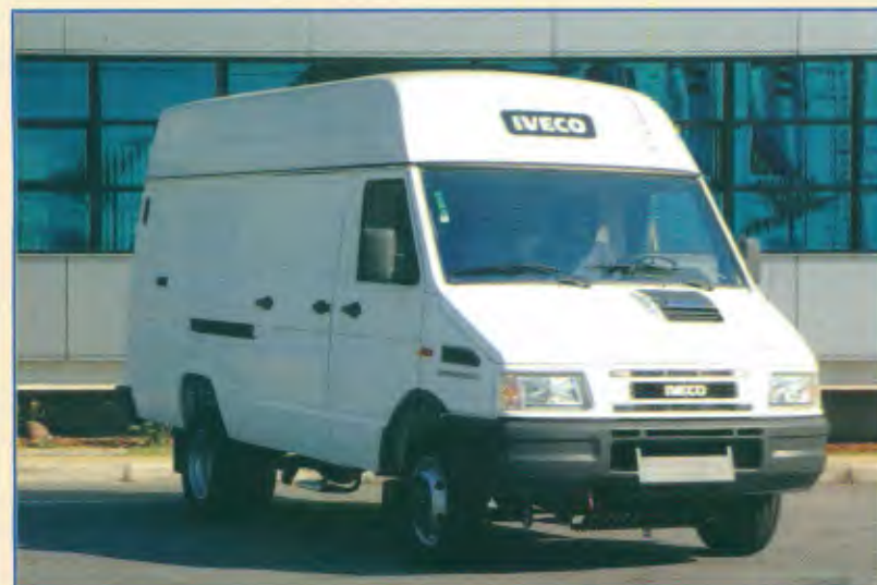
Modelo: Daily 35.10 Entre-eixos: 3.300 mm Motor: Iveco 2.8 Turbo, 103 cv a 3.600 rpm PBT: 4.000 kg, 4.700 kg
