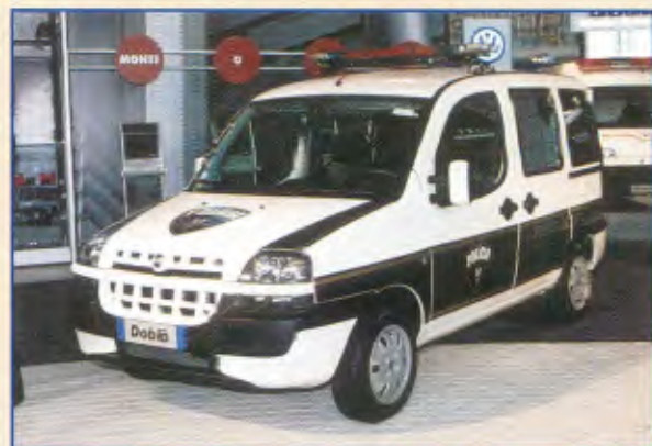
Modelo: Doblò ELX 1.6 16V Entre-eixos: 2.570 mm Motor: 106 cv a 5.500 rpm PBT: 1.810 kg
