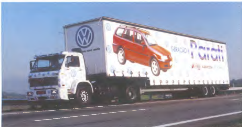
Conjunto cavalo com carreta de dois eixos tipo sider destinado à movimentação de peças e componentes entre as fábricas da Volkswagen
