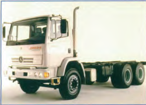
Modelo: 2423 B 6x4 Entre-eixos: 3.600 mm+1.350 mm Motor: OM 906 LA, 231 cv PBT: 26.500 kg PBTC: 32.000 kg
