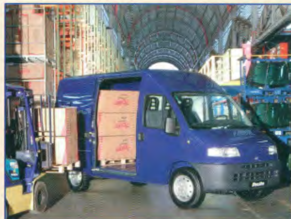
Modelo: Ducato Maxi 4x2 Entre-eixos: 3.200 mm Motor: Sofim 2.8 Turbodiesel, 103 cv a 3.600 rpm PBT: 3.500 kg
