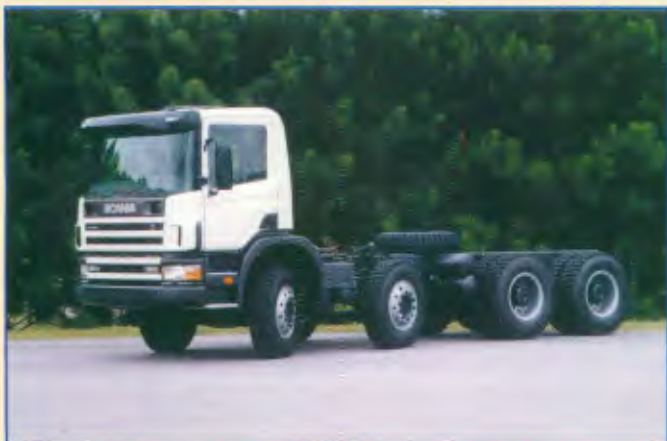
Modelo: P124 CB 8x4 NZ Entre-eixos: 4.100 mm Motor: DSC12 02, 360 cv a 1.300/1.900 rpm PBT: 47.000 kg PBTC: Até 150.000 kg
