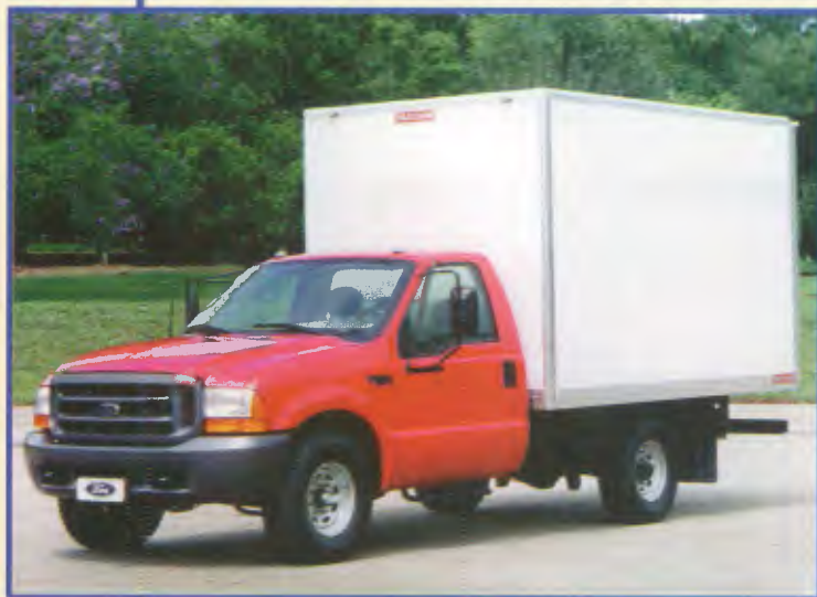
Modelo: F 350 4x2 Entre-eixos: 3.582 mm Motor: Cummins B3.9, 141 cv a 2.700 rpm PBT: 4.500 kg
