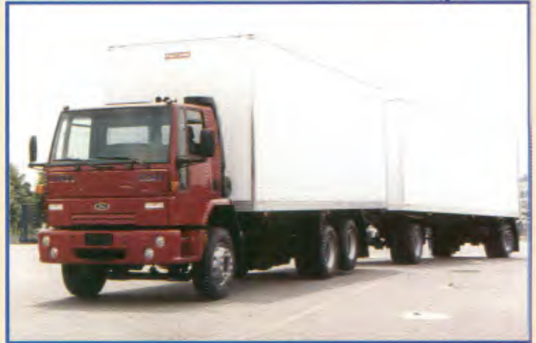
Modelo: Cargo 1630 6x2 Entre-eixos: 4.800 mm Motor: Cummins 6CTAA, 303 cv a 2.200 rpm PBT: 43.000 kg
