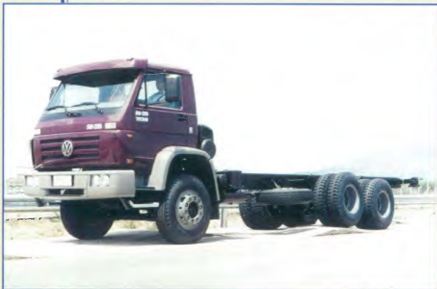
Modelo: 26.310 Titan 6x4 Entre-eixos: 4.120 mm, 5.260 mm Motor: Cummins 6CTAA. 303 cv a 2.200 rpm PBT: 23.000 kg PBTC: 42.000 kg
