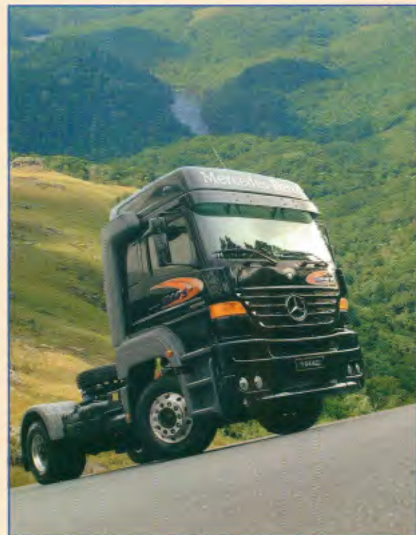
Modelo: 1944 S 4x2 Entre-eixos: 3.700 mm Motor: OM 457 LA, 435 cv PBTC: 45.000 kg, 80.000 kg
