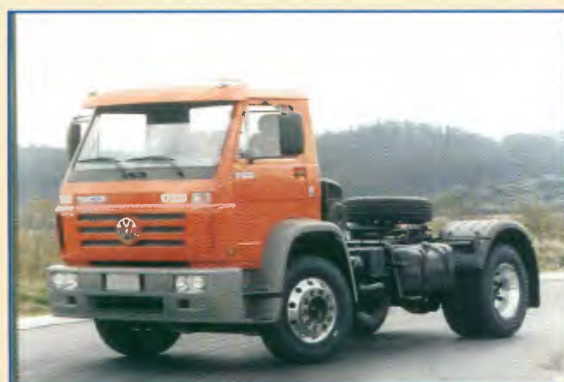
Modelo: 17.220 4x2 Entre-eixos: 3.560 mm, 4.240 mm, 4.800 mm, 5.207 mm Motor: Cummins 6CTAA, 218 cv a 2.200 rpm PBT: 27.000 kg (redução simples), 35.000 kg (dupla)
