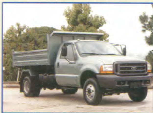
Modelo: F 4000 4x2 Entre-eixos: 4 181 mm Motor: Cummins B3.3, 141 cv a 2.700 rpm PBT: 6.800 kg
