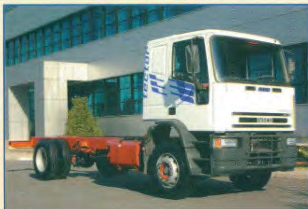
Modelo: EuroCargo Tector 4x2 Entre-eixos: 4.815 mm Motor: Iveco 5.9 Turbo-intercooler, 210 cv a 2.700 rpm PBT: 16.000 kg, 17.500 kg
