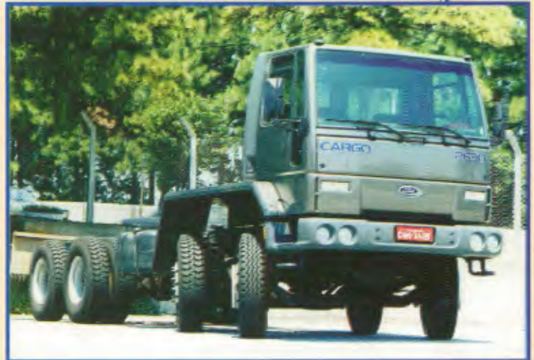
Modelo: Cargo 2630 8x2 Entre-eixos: 4.800/5.940 mm Motor: Cummins 6CTAA, 303 cv a 2.200 rpm PBT: 23.000 kg
