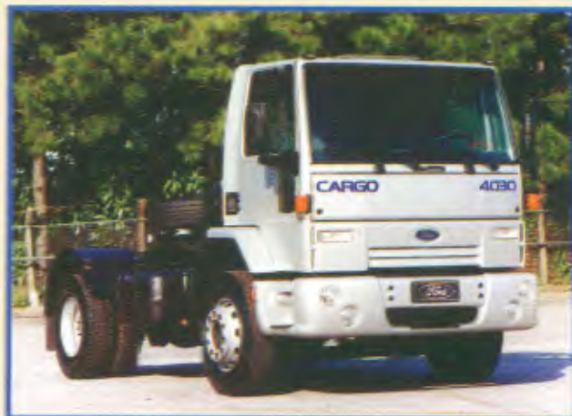
Modelo: Cargo 4030 4x2 Entre-eixos: 3.560 mm Motor: Cummins 6CTAA, 303 cv a 2.200 rpm PBTC: 40.000 kg
