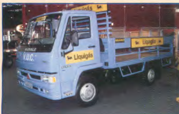
Modelo: Furgon 6.000 4x2 Entre-eixos: 3.650 mm Motor: MWM, 131 cv a 3.500 rpm PBT: 5.900 kg
