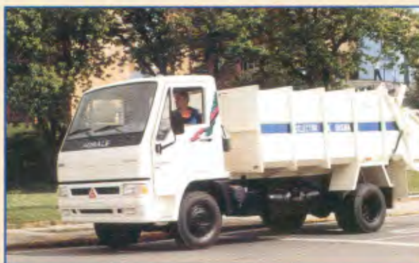
Modelo: 8.500 4x2 Entre-eixos: 3.500 mm, 4.200 mm Motor: MWM, 135 cv a 2.600 rpm PBT: 8.000 kg
