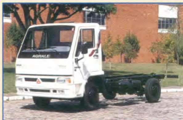
Modelo: 6.000 RS 4x2 Entre-eixos: 3.350 mm, 3.500 mm Motor: MWM, 131 cv a 3.500 rpm PBT: 5.000 kg
