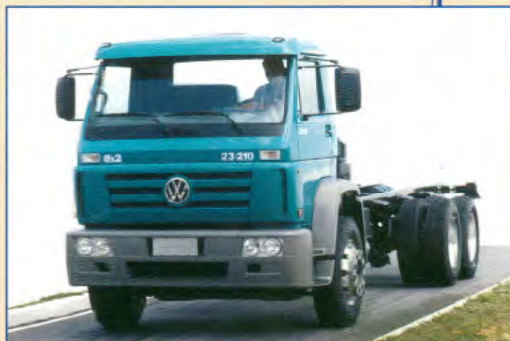
Modelo: 23.210 6x2 Entre-eixos: 3.560 mm, 4.340 mm, 4.800 mm, 5.207 mm Motor: Cummins 6BTAA, 214 cv a 2.600 rpm, MPW 6.10 TCA, 206 cv a 2.600 rpm PBT: 23.000 kg PBTC: 34.000 kg
