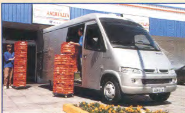
Modelo: Furgon 6.000 4x2 Entre-eixos: 3.650 mm Motor: MWM, 131 cv a 3.500 rpm PBT: 5.900 kg
