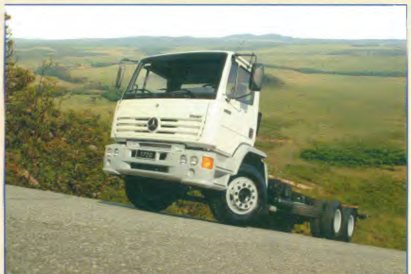
Modelo: 1720 6x2 Entre-eixos: 4.830 mm+1.360 mm Motor: OM 366 LA, 211 cv PBT: 23.000 kg
