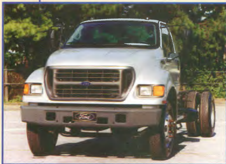
Modelo: F 12000 4x2 Entre-eixos: 4.013 mm, 4.470 mm, 4.928 mm Motor: Cummins B5.9, 162 cv a 2.600 rpm PBT: 11.800 kg
