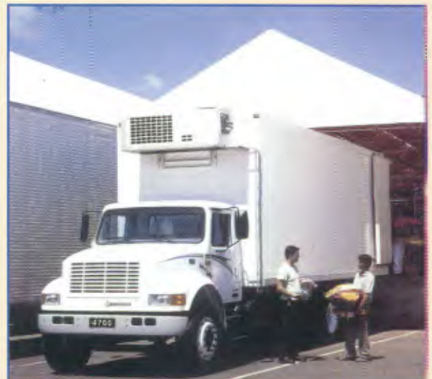
Modelo: 4700 4x2 Entre-eixos: 5.540 mm Motor: International T 444E, 197 cv a 2.300 rpm PBT: 16.000 kg
