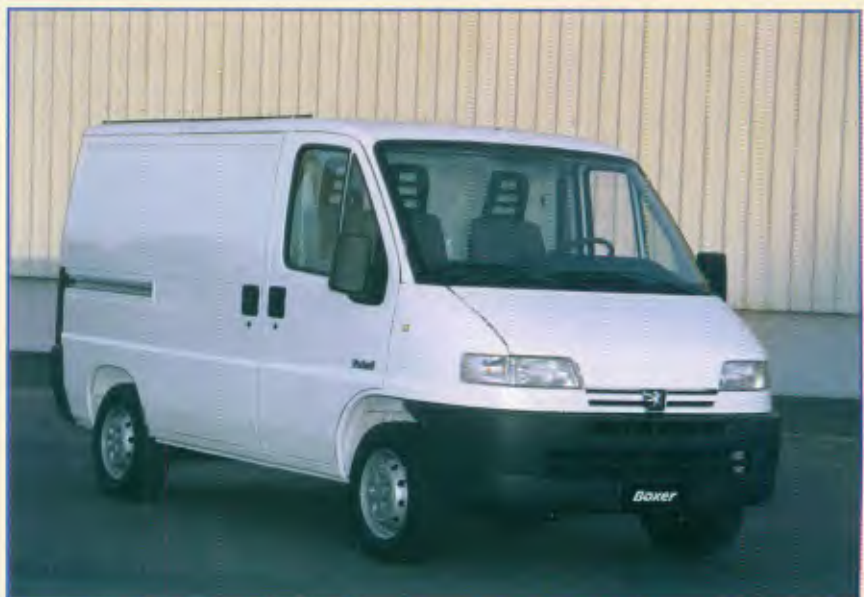
Modelo: Boxer Furgão Médio Entre-eixos: 3.200 mm, 3.200 mm Motor: 103,3 cv a 3.600 rpm PBT: 3.300 kg
