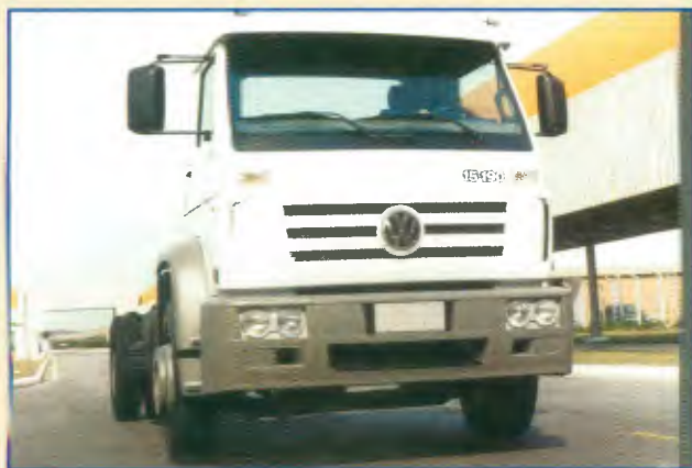
Modelo: 15.190 4x2 Entre-eixos: 3.560 mm, 4.340 mm, 4.800 mm, 5.207 mm Motor: Cummins 6BTAA, 192 cv a 2.600 rpm PBT: 14.500 kg (22.000 kg com 3º eixo)
