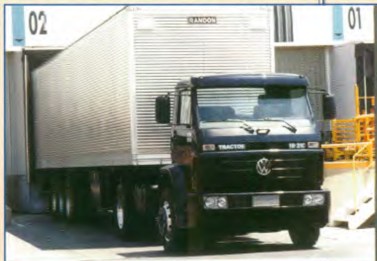
Modelo: 18.310 Tractor 4x2 Entre-eixos: 3.560 mm Motor: Cummins 6CTAA, 303 cv a 2.200 rpm PBT: 42.000 kg
