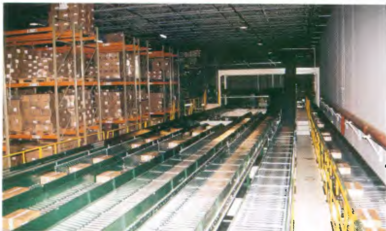
Esteira automatizada, um equipamento fundamental, que lê código de barras e acelera o processo de distribuição
