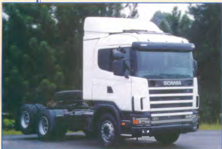
Modelo: T124 GA 6x4 NZ Entre-eixos: 3.700 mm Motor: DSC12 05, 420 cv a 1.700/1.300 rpm PBT: 27.700 kg PBTC: Até 78.000 kg
