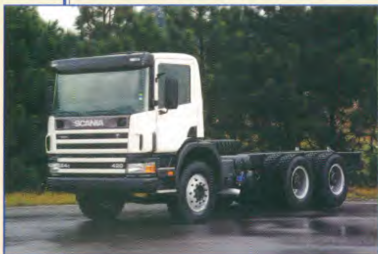
Modelo: P124 CB 6x4 NZ Entre-eixos: 3.300 mm, 4.700 mm Motor: DSC12 05, 420 cv a 1.700/1.800 rpm PBT: 38.500 kg PBTC: Até 150.000 kg
