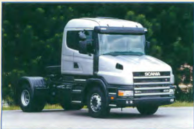
Modelo: T124 GA 4x2 NZ Entre-eixos: 4.300 mm Motor: DSC12 01, 400 cv a 1.800/1.900 rpm PBT: 19.700 kg PBTC: Até 80.000 kg
