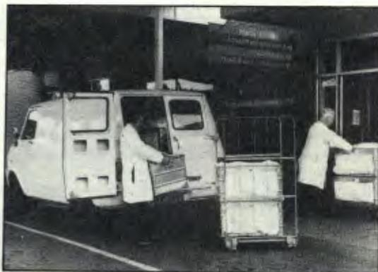
Equipamento com bateria de 1t, o furgão leva 1 t de carga líquida
