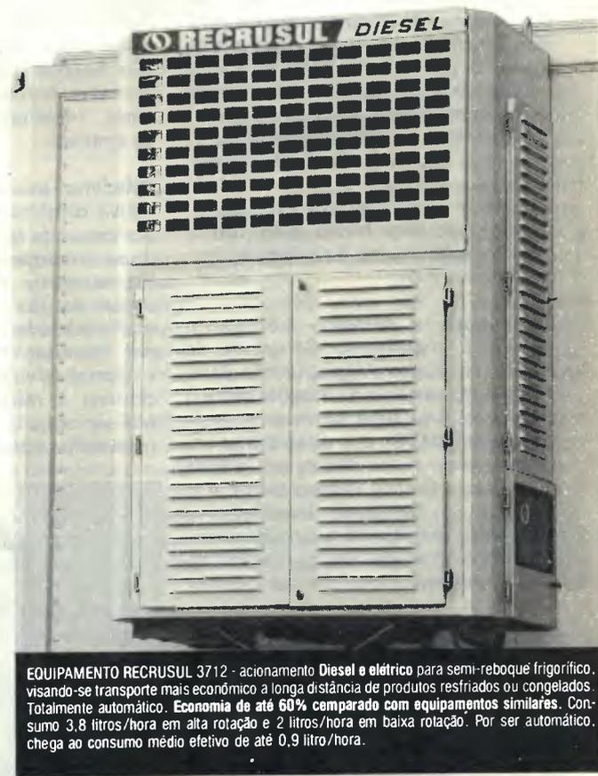
EQUIPAMENTO RECRUSUL 3712 - acionamento Diesel e elétrico para semi-reboque frigorífico, visando-se transporte mais econômico a longa distância de produtos resfriados ou congelados. Totalmente automático. Economia de até 60% comparado com equipamentos similares. Consumo 3,8 litros/hora em alta rotação e 2 litros/hora em baixa rotação. Por ser automático, chega ao consumo médio efetivo de até 0,9 litro/hora.
