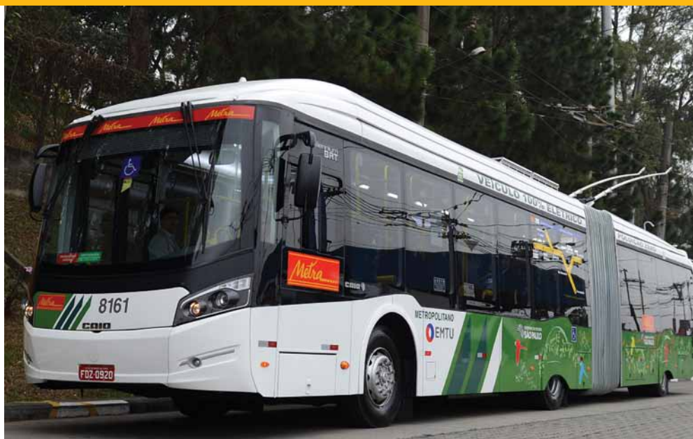
Mesmo sem estar conectado à rede elétrica, o novo trólebus pode se deslocar por 7 km
