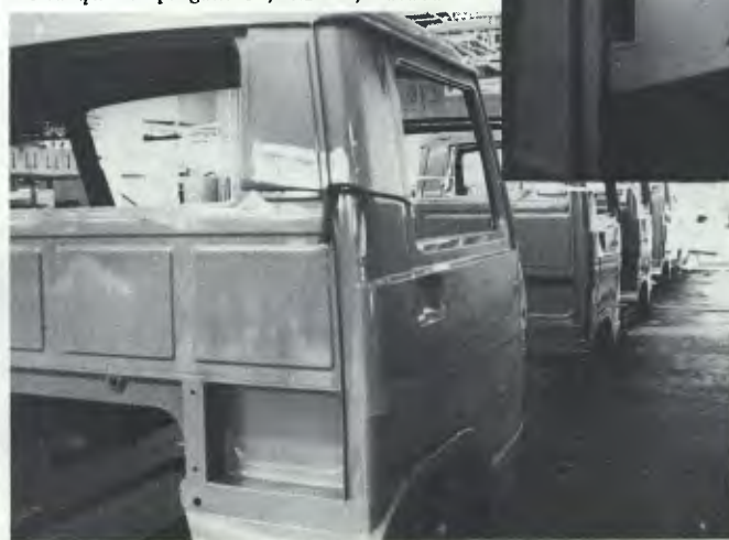
Na pintura eletroforética a tinta migra para todos os pontos da cabina
