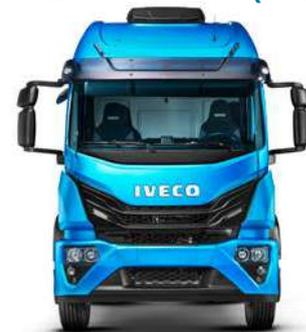
**Tecnologias destinadas a operação:** Espelho de aproximação - série ; Espelho retrovisor elétrico - série; Vidros elétricos - série ; Trava elétrica - série ; Ar condicionado - série; Chave seccionadora de bateria - série, Lanterna LED - opcional; Viseira para sol - opcional; Rádio - série; Climatizador - série. **Tecnologias destinadas a sistema de segurança:** ABS, EBD, ATC, HAS, ESC, ESS - série. **Tecnologias destinadas para gestão de frotas:** IvecoON - 1 ano gratuito após a compra.
