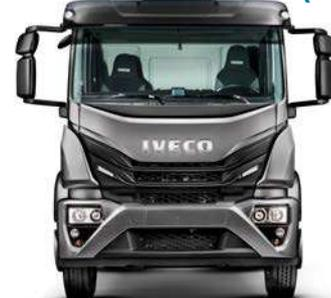
**Tecnologias destinadas a operação:** Espelho de aproximação - série; Espelho retrovisor elétrico - série; Vidros elétricos - série; Trava elétrica - série; Ar condicionado - série; Chave seccionadora de bateria - série, Lanterna LED - opcional; Viseira para sol - opcional; Rádio - série. **Tecnologias destinadas a sistema de segurança:** ABS, EBD, ATC, HAS, ESC, ESS - série. **Tecnologias destinadas para gestão de frotas:** IvecoON - opcional.
