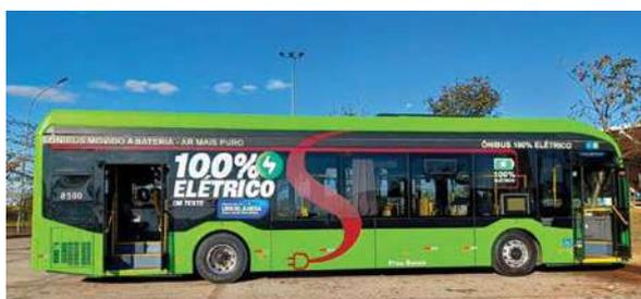
D9W tem 12,98 metros de comprimento, piso baixo e autonomia de até 250 quilômetros. O veículo, com
