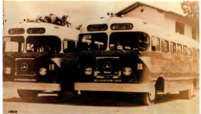
Carroceria que marcou a chegada da chapa de aço no revestimento lateral e no teto
