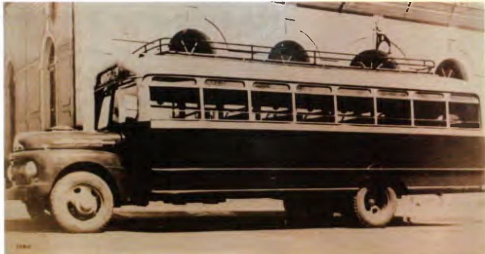
Carroceria ano 1950, de madeira, feita para a frotista Abílio Bello & Cia sobre chassi e frontal Ford 1950 F-6
