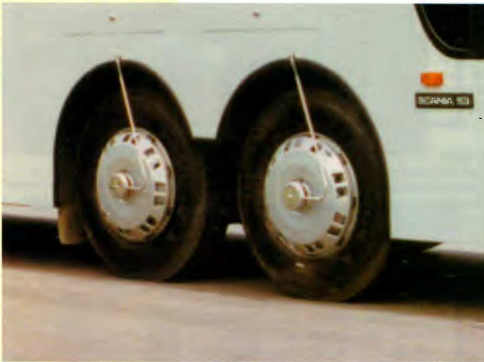
A HVR, de Joinville, alonga chassis e faz a instalação de segundos e terceiros-eixos
