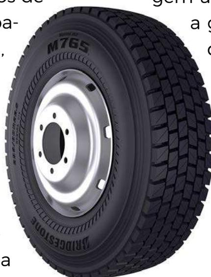
Bridgestone pneu radial M765 desenvolvido para eixos de tração em rodovias pavimentadas de curta, média e longa distância
