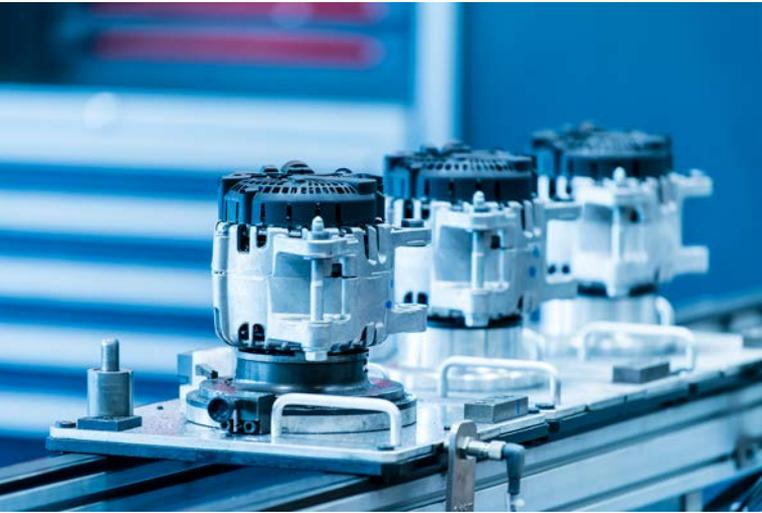
Sistema iBSG recupera energia elétrica durante os momentos de desaceleração e frenagem do veículo, armazenando-a em baterias
