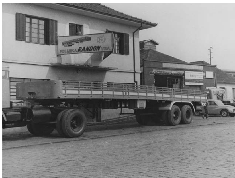
Semirreboque de dois eixos, criação de Hercílio Randon na década de 1960
