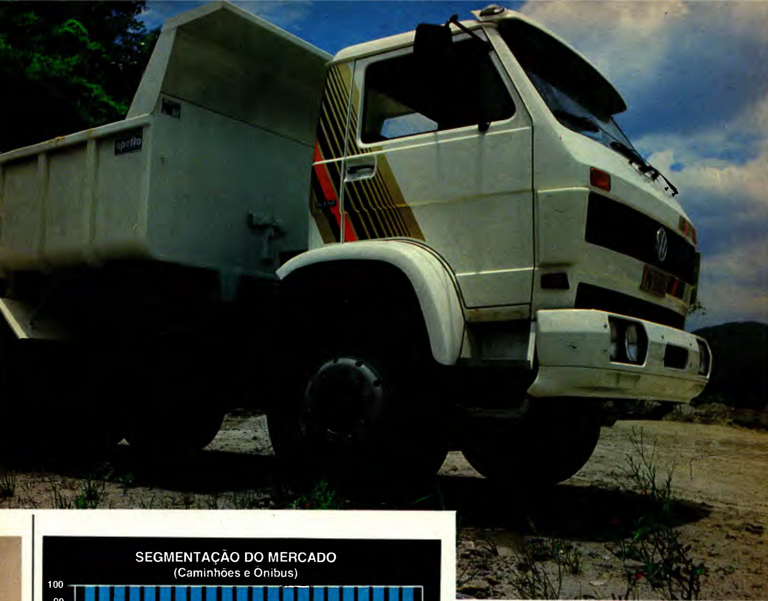
Em cinco diferentes opções de entreeixos, os caminhões de 16 t, da Volkswagen, podem operar no trabalho pesado das pedreiras, rebocar carreta de dois eixos, na versão cavalo mecânico, entre outras. Ao lado, a evolução dos diferentes segmentos do mercado.
