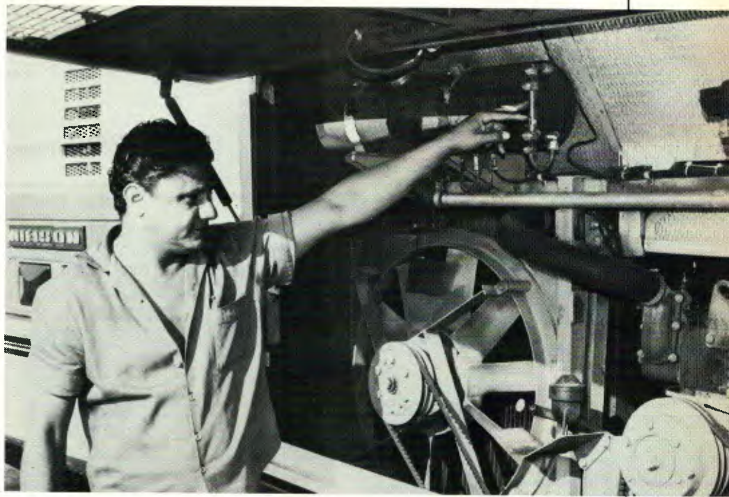
A solda das caixas e o cuidado com o aditivo da água do radiador são recomendações de Luiz, Dario e Eurípedes para prolongar a vida útil do radiador
