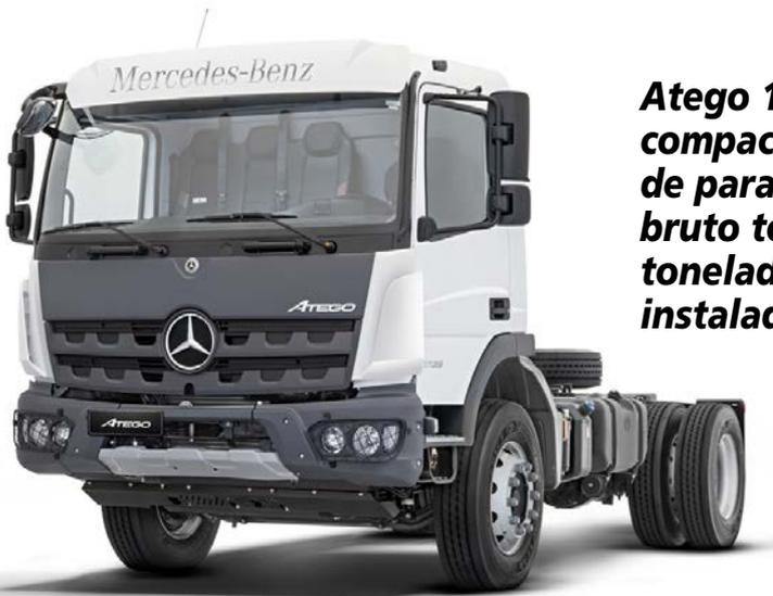
**Atego 1719 vocacional como compactador de lixo, tem capacidade para 17,1 toneladas de PBT (peso bruto total), podendo chegar a 24,1 toneladas de PBT com terceiro eixo instalado por empresas implementadoras**
