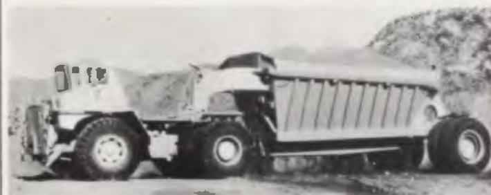
Para transporte de grandes volumes a longa distância, a Caterpillar lançou o cavalo-mecânico fora-de-estrada 772. Projetado para unidades rebocadas de 90 a 140 t, o 772 oferece potência, suspensão e freagem nas suas aplicações, especialmente em mineração e construção.
