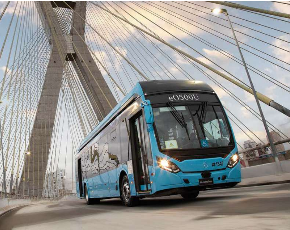
O e0500U é um modelo Padron 4x2 de piso baixo, para carrocerias de até 13,2 metros
