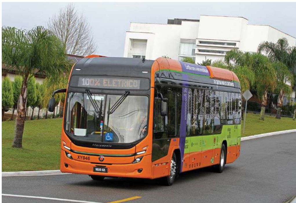
O BZL elétrico, chassi 4x2 destinado a operações urbanas e metropolitanas
