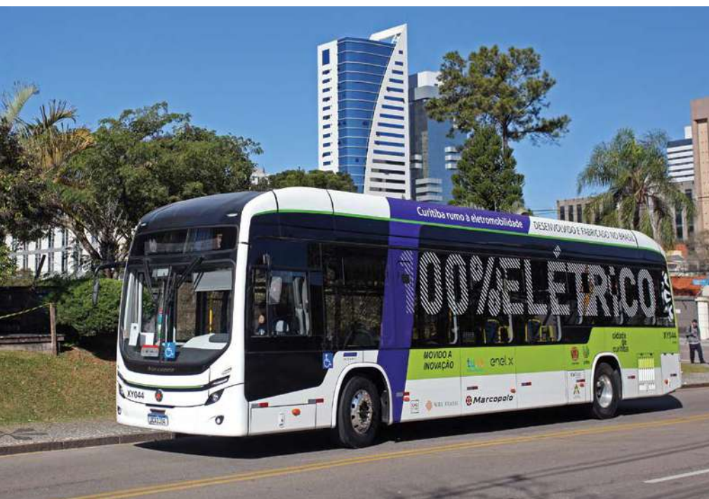
O Attivi Integral 100% elétrico tem autonomia entre 250 e 280 km
