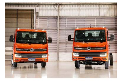
O VW Delivery 11.180 é indicado para entregas urbanas e tem peso bruto total de 10.800 kg, destacando como vantagem a maior plataforma de carga da categoria, o que garante alta produtividade deste veículo. O motor é Cummins ISF 600 Nm de torque e 175 cv de potência. São duas opções de transmissões: manual e automatizada.
