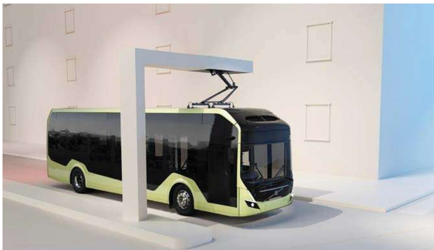
BZL 100% elétrico é um veículo Padron 4x2 com entrada baixa
