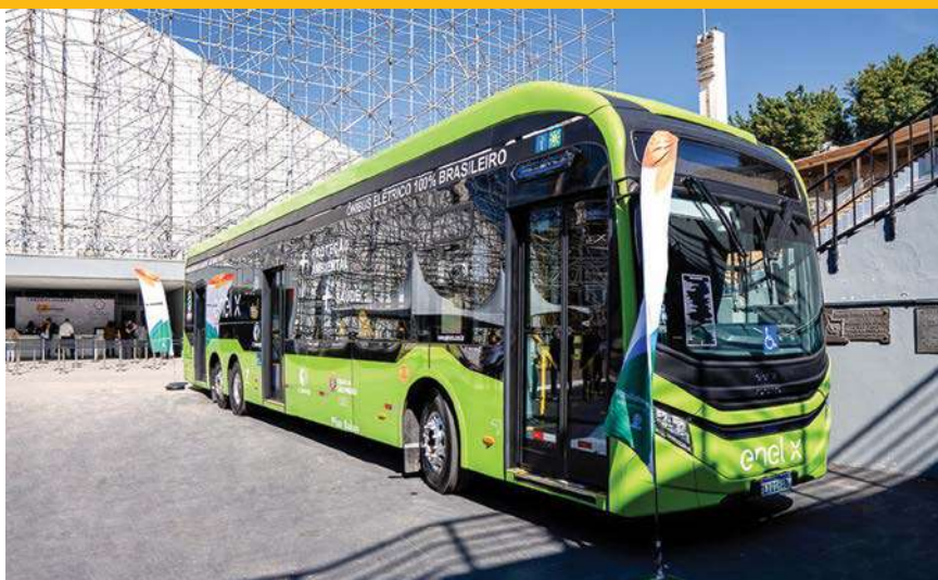
Caio eMillennium, com chassi Scania, versão de 15 metros, com carroceria para chassis movidos à propulsão elétrica por bateria
