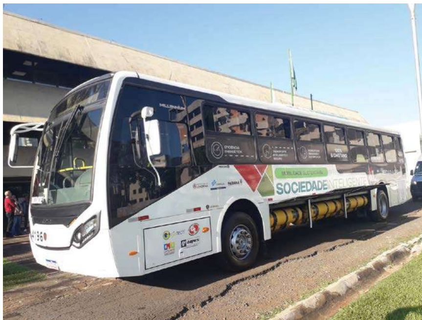
O ônibus movido a biometano é o modelo padron K 280 4x2, com 14 metros de comprimento e capacidade para 86 passageiros
