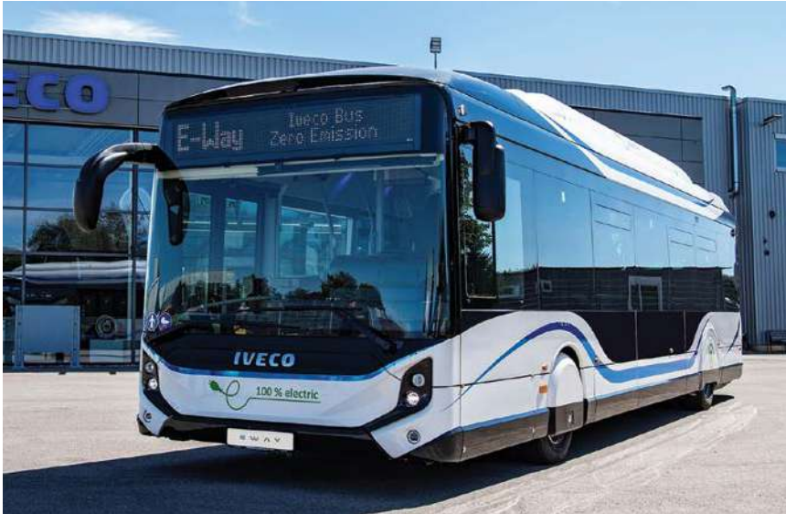
Iveco E-Way tem 12 metros de comprimento, com PBT de 20 toneladas, piso low-floor e pack de oito baterias no teto
