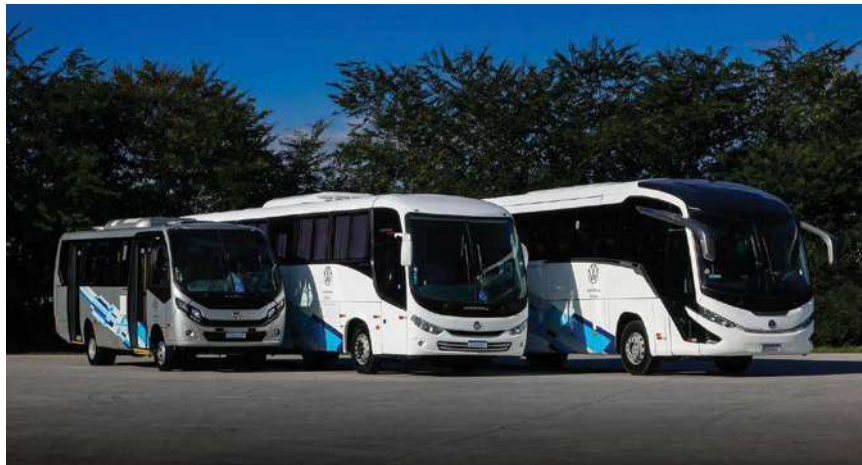
Volksbus, com motor dianteiro D08 de 230 cv, recebe carrocerias de até 13,6 metros
