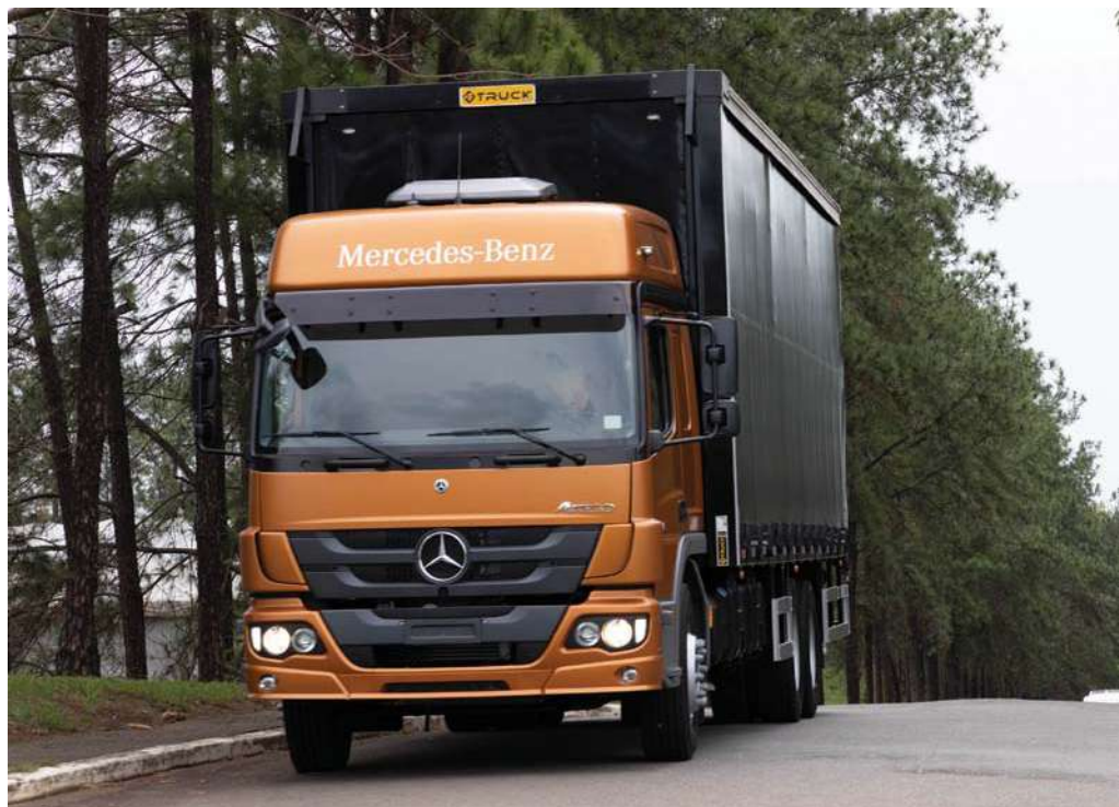
Os modelos Atego 2023 são equipados com motor OM 926 LA de 260 cv, 286 cv e 321 cv de potência
