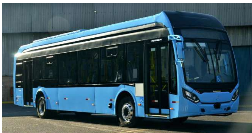
Em Sorocaba, os ônibus serão do modelo padron, a partir de 12,5 m. de comprimento, chassi Mercedes-Benz, carroceria Caio, baterias WEG, freios ABS elétricos e sistema de regeneração de energia
