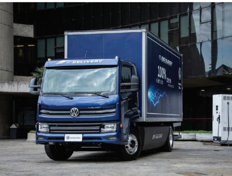
**O e-Delivery de 11 toneladas 4x2 está equipado com motor de 300 kW com torque máximo de 2.150 Nm**
