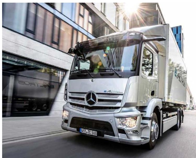
**Conforme a versão, o eActros utiliza três ou quatro baterias, cada uma com uma capacidade de cerca de 105 kWh.**
