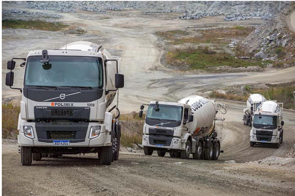
4.550mm é ideal para melhor distribuição de peso na betoneira. Mesmo mais curto, o modelo tem tanques de combustível de 200 litros e de Arla32 de 50 litros, podendo rodar o dia todo sem reabastecimento. Outra inovação é o quarto eixo direcional dianteiro, que diminui o arraste dos pneus e permite manobras em raios curtos, comuns em canteiros de obra.
