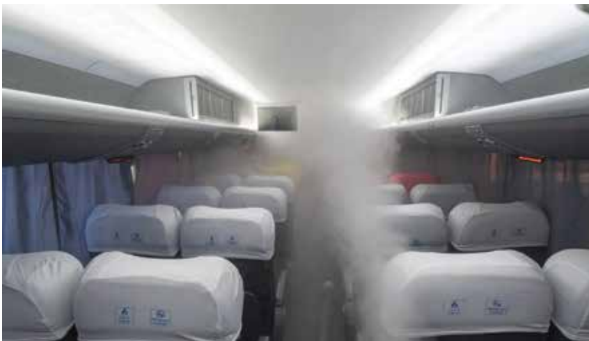
FIP Onboard da Marcopolo, sistema que usa névoa seca para desinfecção do interior do ônibus
