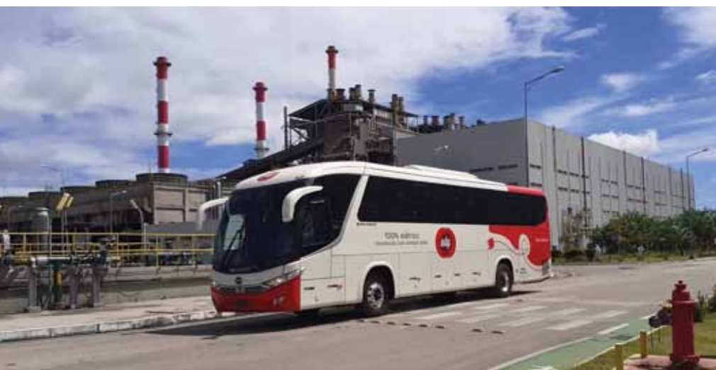
Modelo movido a energia solar tem um banco de baterias que garante autonomia de 300 km
