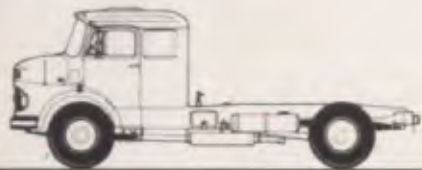
LS-1519, com 4,20m de entre eixos e cabina-leito com duas camas.
