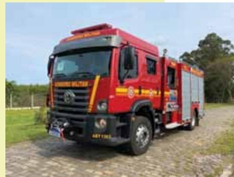
alizadas nos veículos estão a transmissão automática Allison S300, com seis velocidades à frente e uma à ré; preparação para governador de pressão, permitindo controle preciso do regime de pressão da bomba de incêndio; baterias adicionais e alternador de 120 amperes, a fim de suportar toda a instalação elétrica e os equipamentos de uma viatura de bombeiro.
